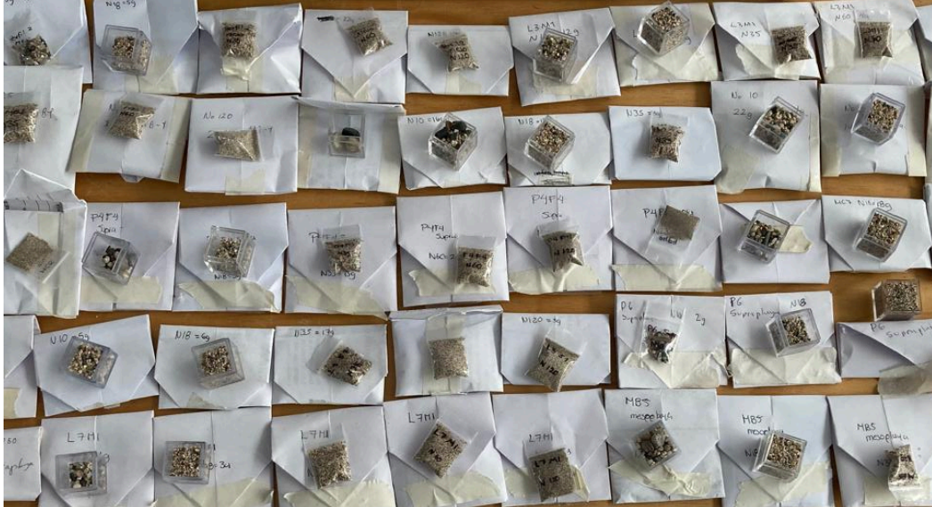
Figura 21. Imagen representativa de cómo se ingresaron las muestras a los cubos de acrílico.
