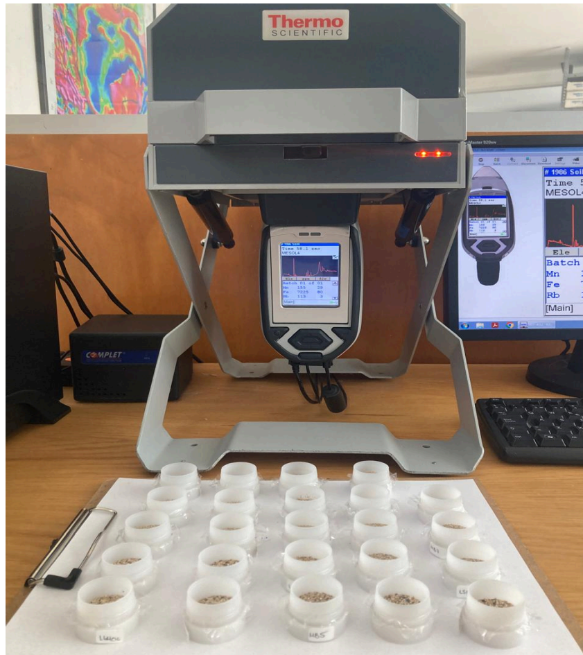
Figura 22. Imagen de la preparación de las muestras antes de que entren a la FRX
