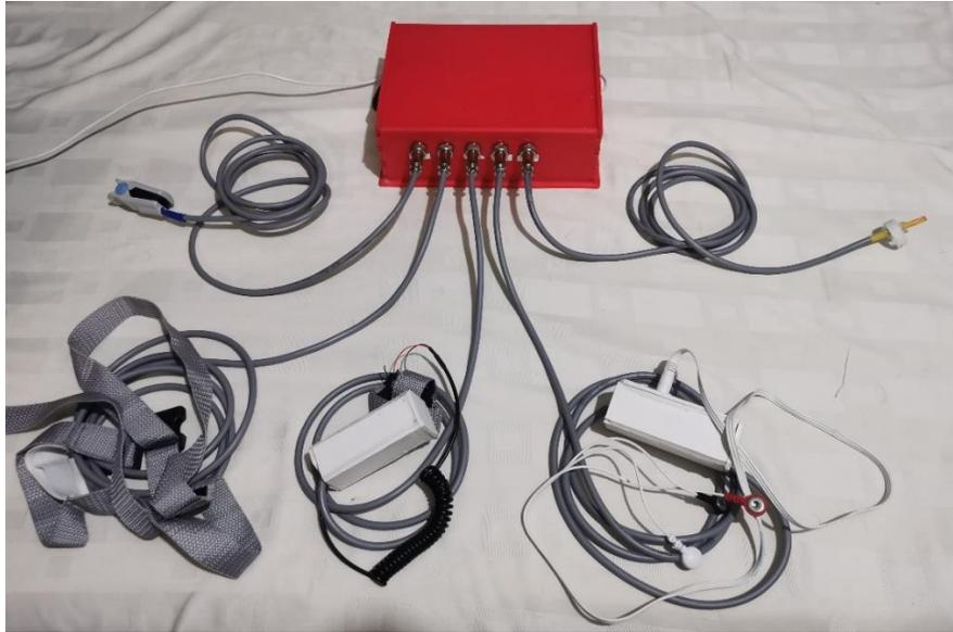
Fig. 38. Prototipo con todos los sensores conectados.
