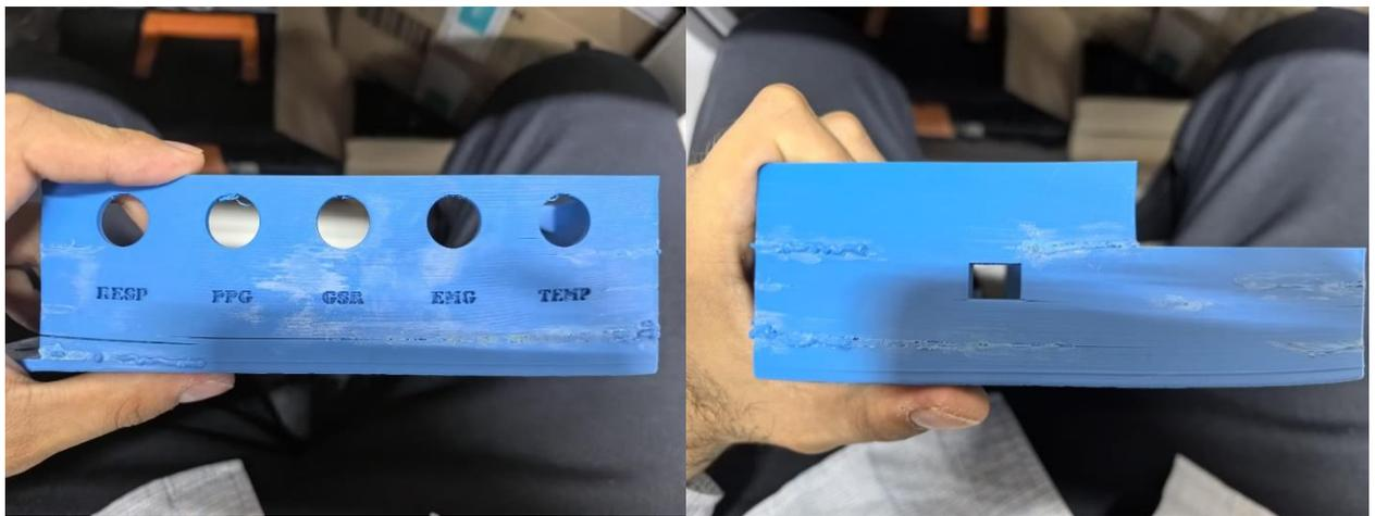
*Fig. 35 Errores de impresión presentados en primer prototipo*
