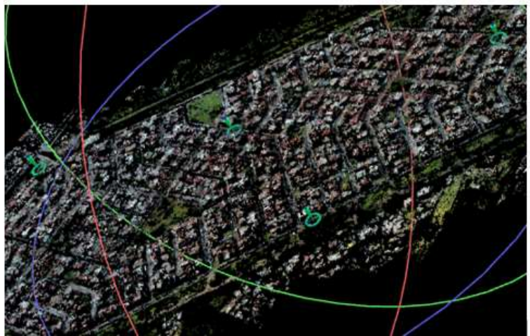
Ilustración 30 Imagen superior muestra PC ingresados (marcas azules) y puntos según imagen (marcas verdes). Imagen inferior muestra las marcas empalmadas con proyecto reoptimizado. Fuente propia.
