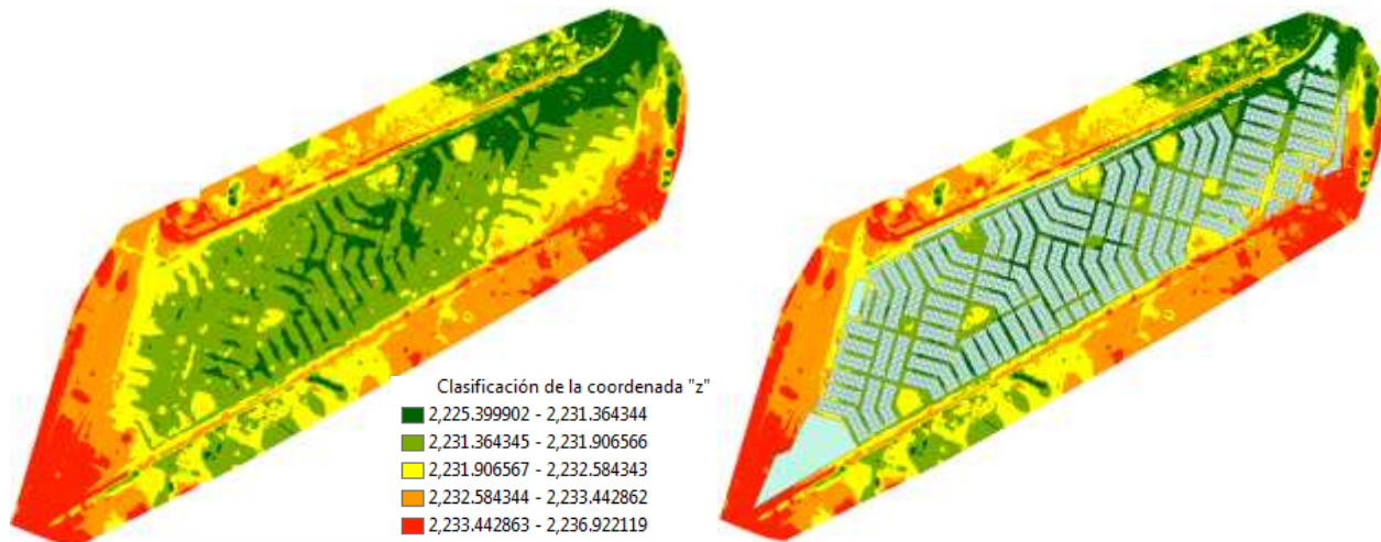
Ilustración 50 A la izquierda MDE de entrada y a la derecha la capa de predios de la colonia. Las zonas más altas se encuentran alrededor de modelo excepto en el noreste que es la desembocadura de la cuenca. Capas con las que corrió el software para obtener los resultados de las siguientes ilustraciones. Fuente propia.
