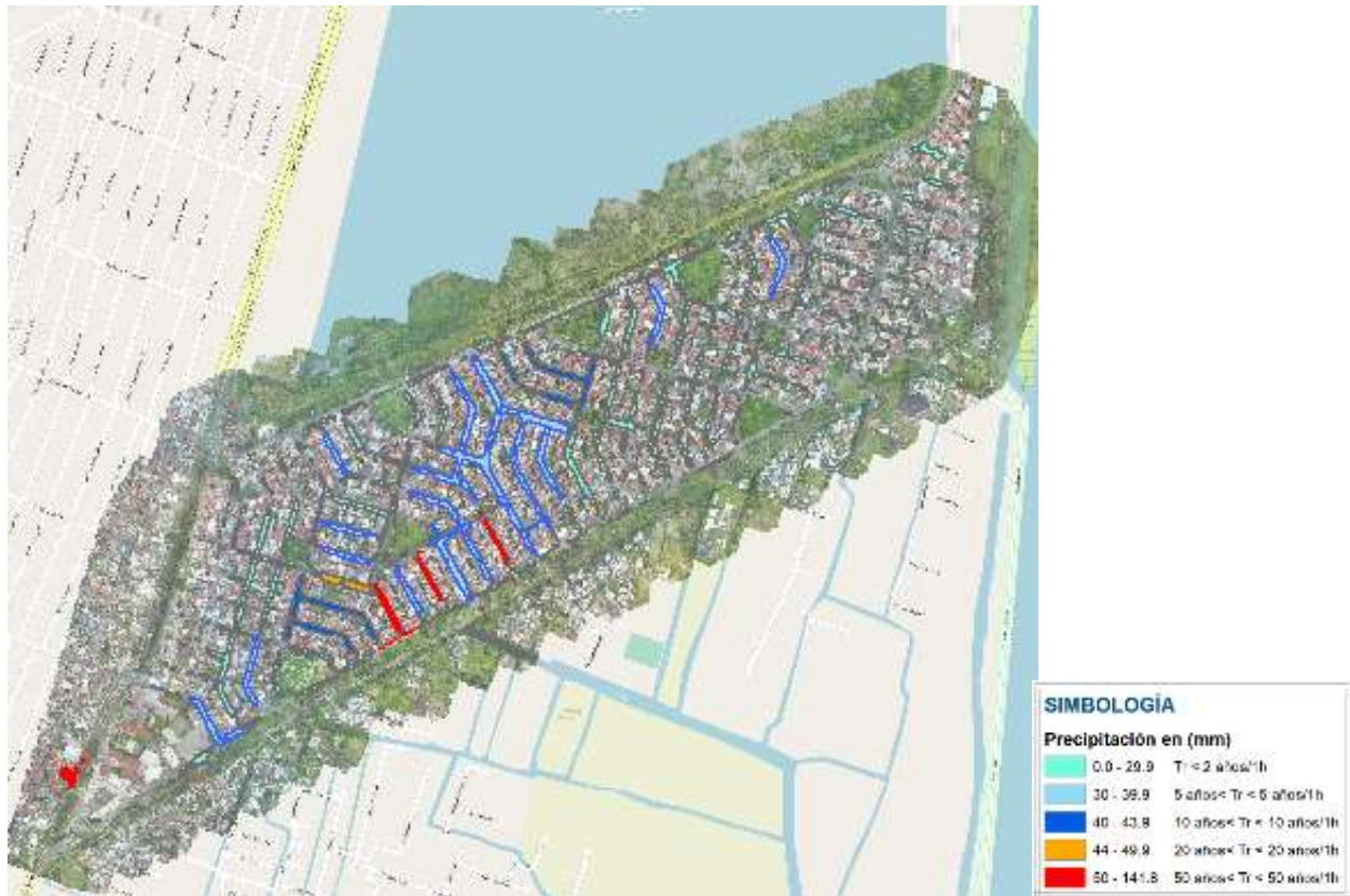
Ilustración 51 mapa 1 "Precipitación y zonas de riesgo". Imagen que muestra las zonas más susceptibles a inundación suponiendo que el alcantarillado es disfuncional. 'Tr' refiere a la tasa de retorno o periodo de retorno. Fuente propia.
