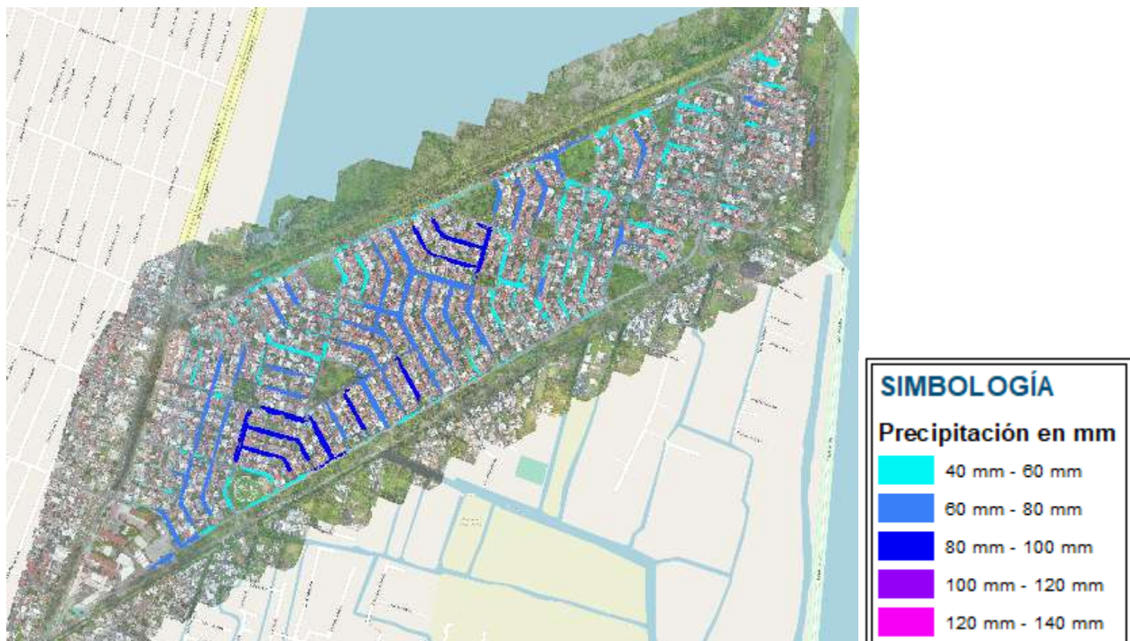
Ilustración 52 Mapa 2 "Precipitación y zonas de riesgo". Zonas susceptibles a inundación con sistema de alcantarillado funcional a 40mm. Tr refiere a la tasa de retorno o periodo de retorno. Fuente propia.
