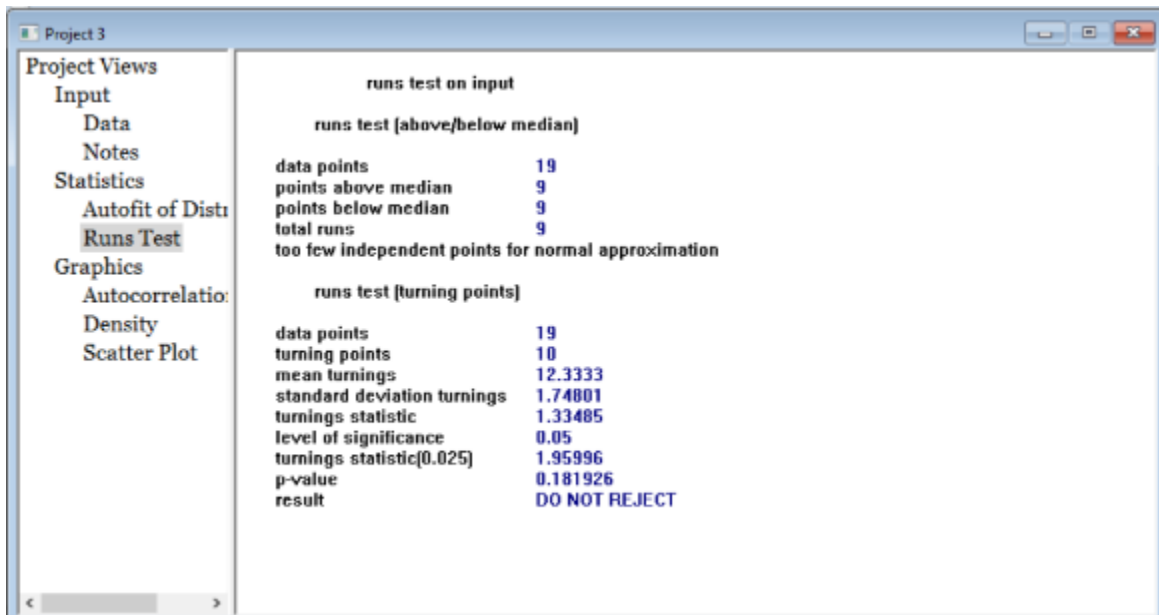
Fig. 20. Prueba de rachas en Proceso de empaquetado máquina 2. Fuente: elaboración propia utilizando ProModel versión estudiantil
