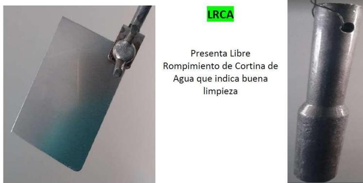
Figura 20. validación del proceso de limpieza (Fuente: Urresko)
