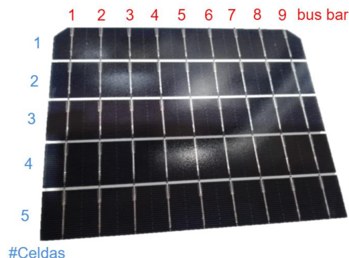
Fig. 62. Conjunto de 5 celdas solares y ubicación de los 9 bus bar.
