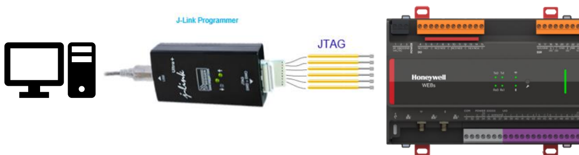
Figura 10: Conexión para descarga de firmware del chip de NORDIC
