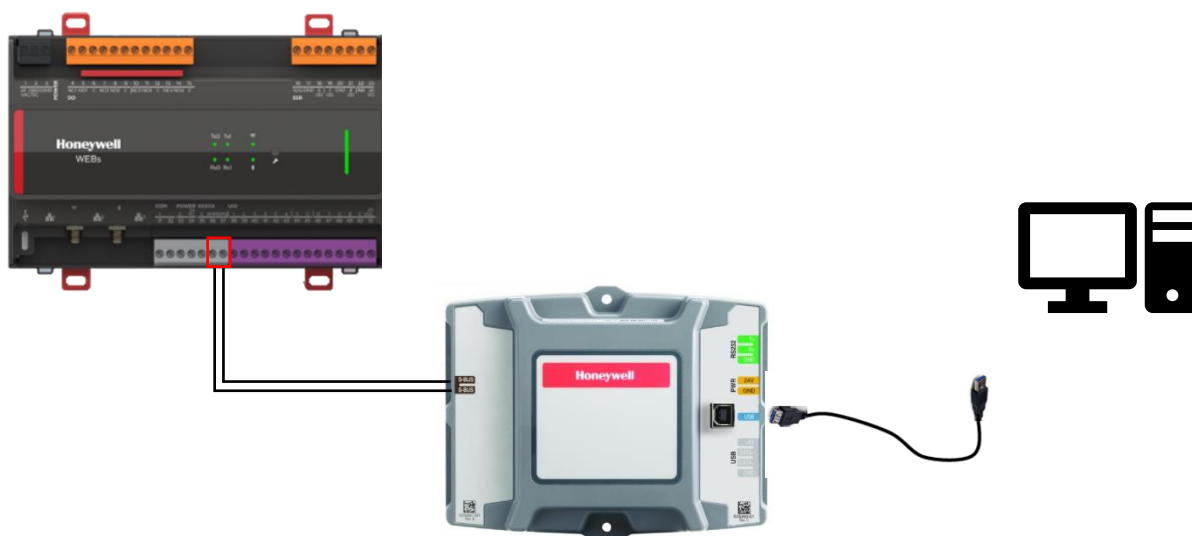
Figura 15: Conexión para sylk usando el W7220 PCMOD
