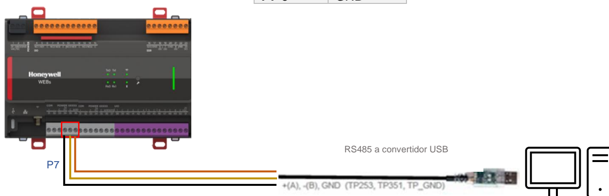
Figura 21: Conexión de la prueba MSTP
