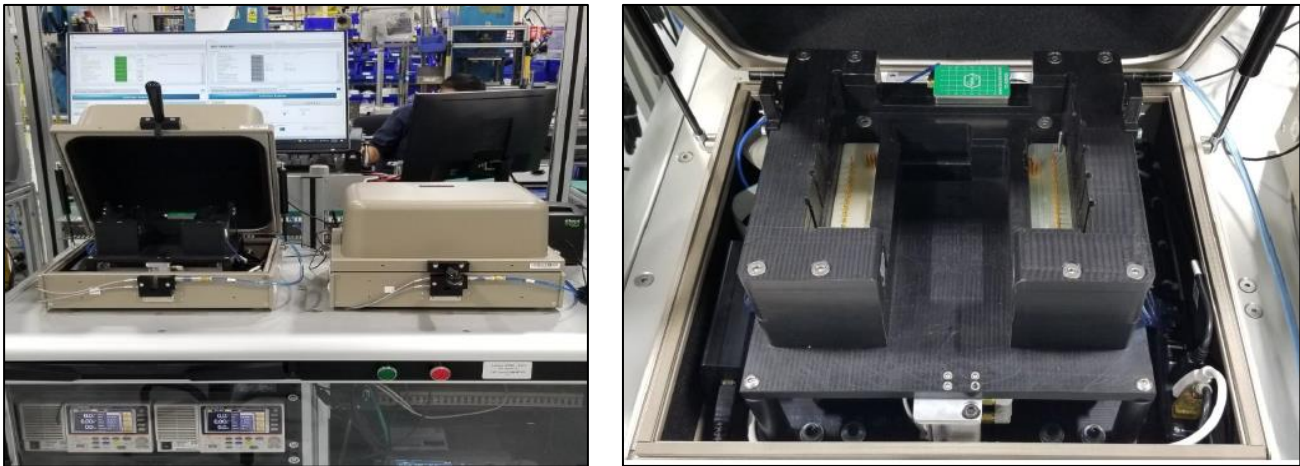
Figura 23: Fixture para la estación 3 donde se realiza el RFT
