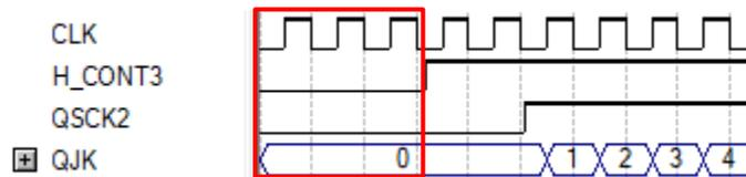
Figura 32. Simulación del contador 3 - ascendente
