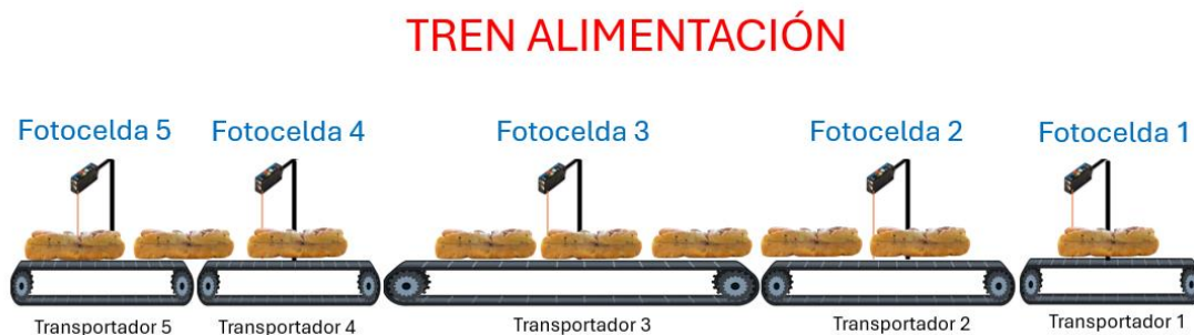
Imagen 5.51. Tren alimentación. Fuente. elaboración propia
