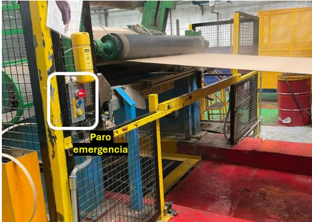
Imagen 3.29. Guarda de seguridades, paro de emergencia alimentador zona 2. Fuente. elaboración propia
