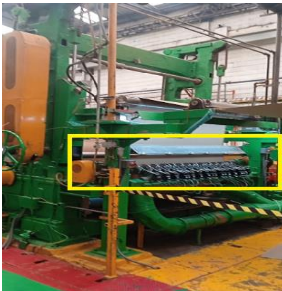
Imagen 3.4. Zona 4 -Cuchillas. Fuente. elaboración propia
