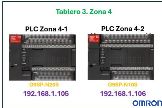
Imagen 3.18. Controladores de Seguridad Tablero 3. Fuente. elaboración propia
