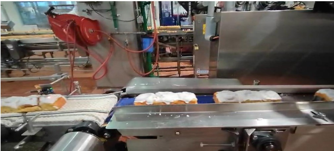
Imagen 5.9. Tren alimentación- Envolvedora. Fuente. elaboración propia
