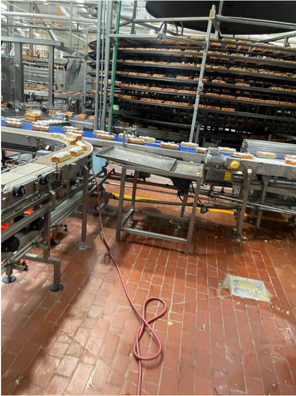
Imagen 5.7. Alimentación Roles a líneas envolveras. Fuente. elaboración propia
