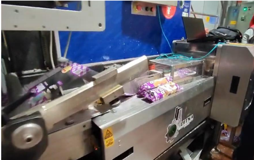
Imagen 5.13. Transportador 1- Envolvedora. Fuente. elaboración propia
