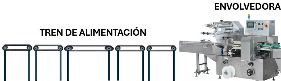
Imagen 5.1. Layout sistema envolvedora-tren de alimentación. Fuente. elaboración propia
