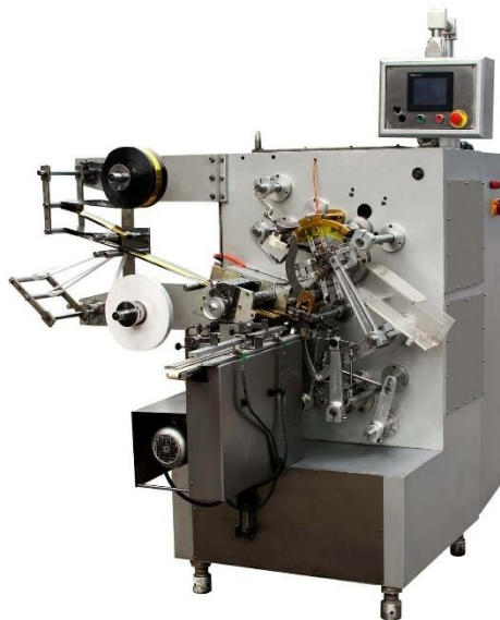
Imagen 5.2. máquina envolvedora. Fuente. elaboración propia
