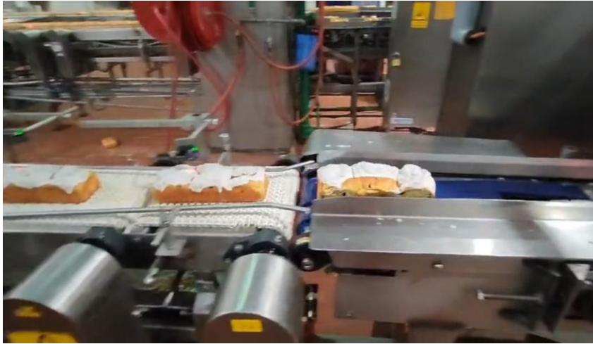
Imagen 5.12. Transportador 1- Entrada envolvedora 2. Fuente. elaboración propia
