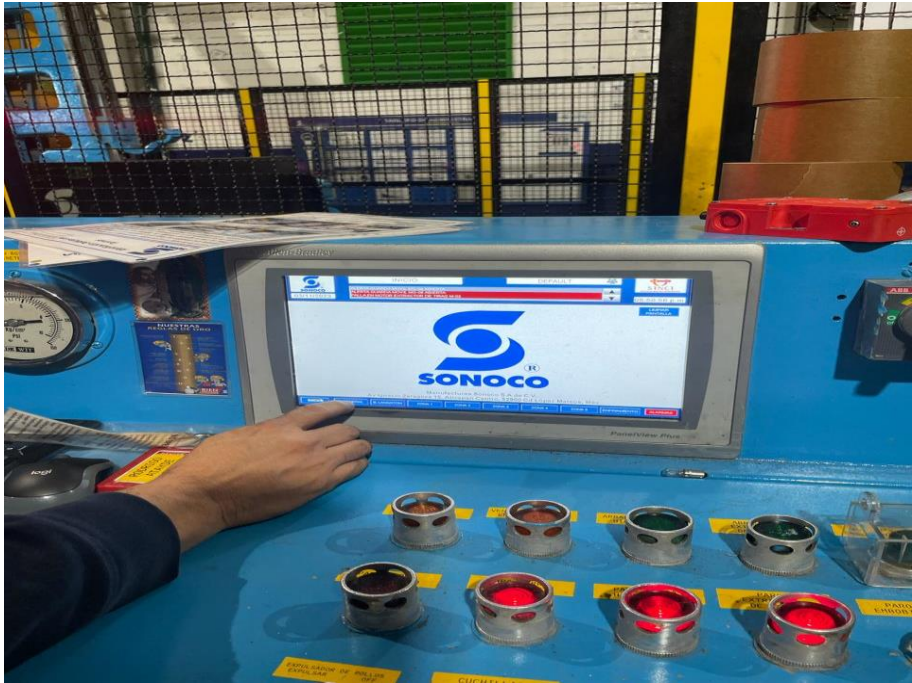
Imagen 3.81. HMI Bobinadora-Reel. Fuente. elaboración propia
