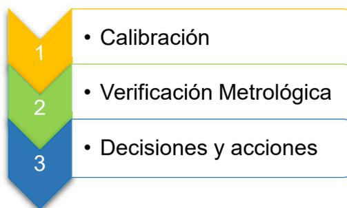
**Figura 2.11** Etapas de la confirmación metrológica de los equipos de medición de acuerdo con la Norma ISO 10012.
