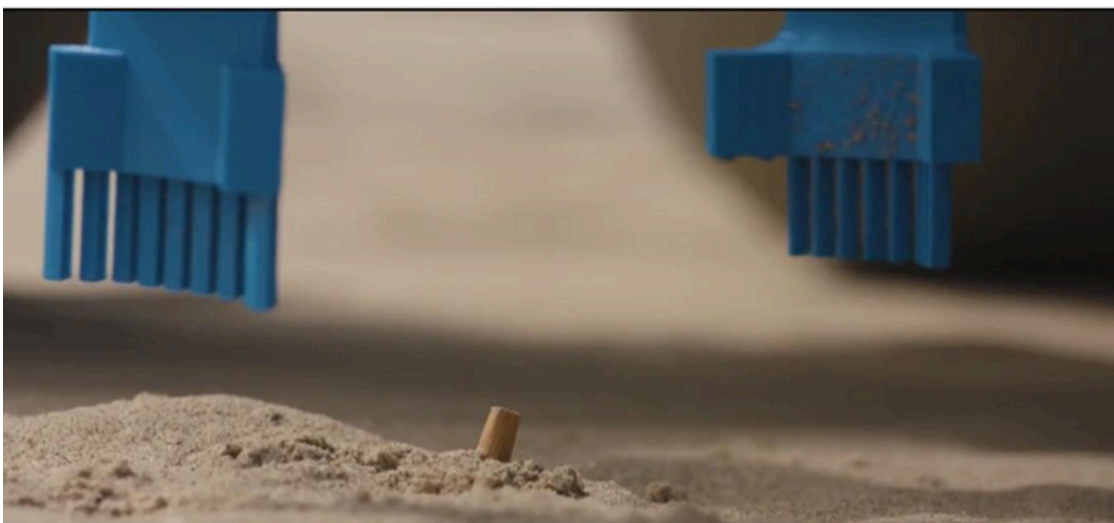
Imagen 2.16 Método de recolección de un prototipo comercial [7]: Bajando su garra para recogerlo
