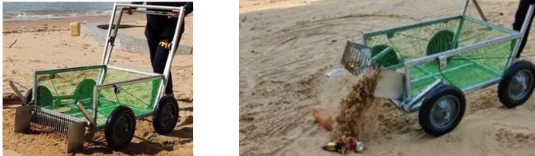
Imagen 1. 1 Prototipo limpiador de playa del artículo: “Fabrication of a motor -less beach-sand cleaning machine for beach resorts”
