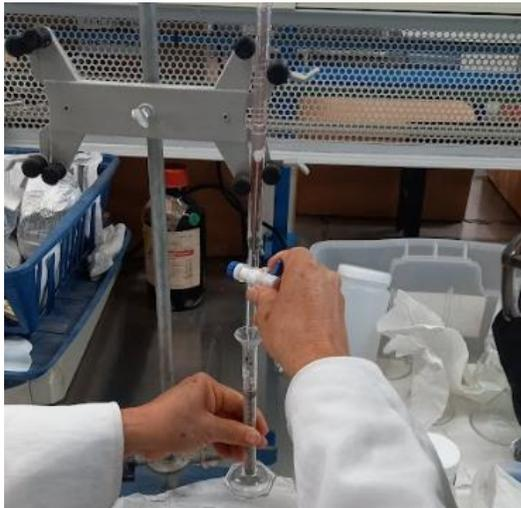
FIGURA IV.4 Agregado de agua en bureta para estimación de densidad aparente
