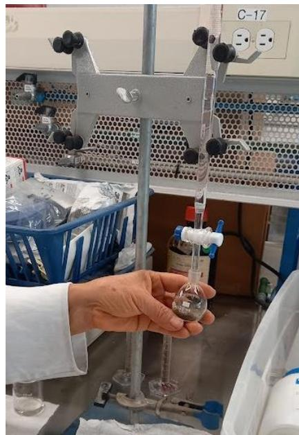
FIGURA IV.2 Agregado de agua a picnómetro
