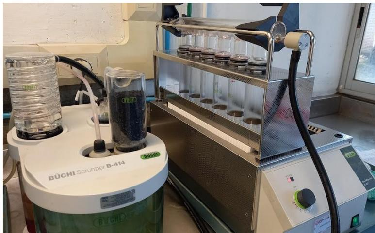
FIGURA IV.19 Tubos BÜCHI con muestras en digestor
