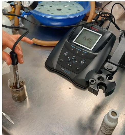
FIGURA IV.1 Lectura de medidor de pH para muestras de suelo
