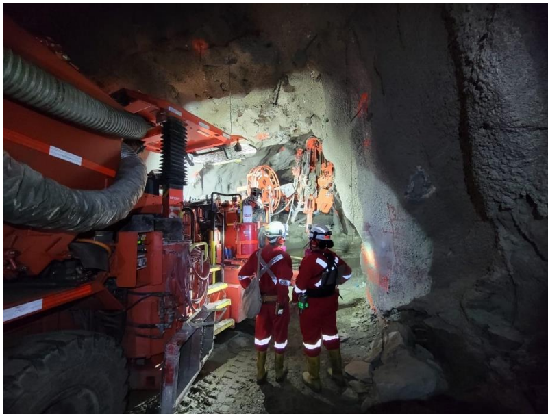
Ilustración 8: Equipo Sandvik DS421 trabajando en rebaje de producción.
