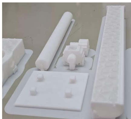
Ilustración 58. Flecha impresa en 3D. Orientada para maximizar sus propiedades mecánicas. (Elaboración propia)
