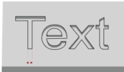
Ilustración 52. Ejemplificación de piezas con detalles imprimibles (Letras grabadas). Obtenido de: [17]
