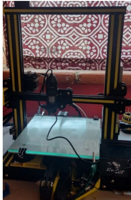
Ilustración 33. Prototipado de cámara con 3 ejes de libertad. (Elaboración propia)
