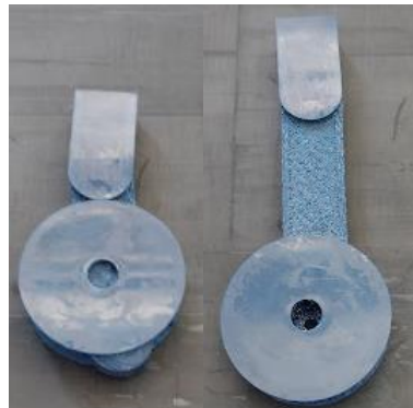
Ilustración 62. Piezas impresas con tolerancias para poder ser impresas en una misma pieza. (Elaboración propia)
