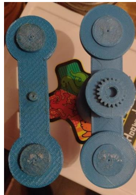
Ilustración 51. Piezas con diferente textura dependiendo la orientación de impresión. (Elaboración propia)
