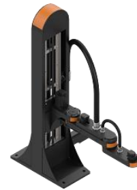
Ilustración 18. Configuración Scara 4GDL. Obtenido de: [28]
