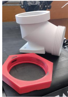
Ilustración 61. Piezas impresas con cuerdas estandarizada. (Elaboración propia)
