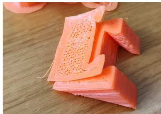
Ilustración 49. Defecto de impresión Warping por ángulos rectos. (Elaboración propia)
