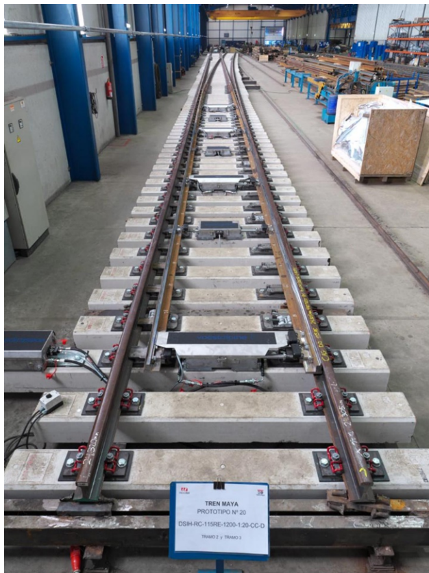
Figura 16. Aparato tipo 15 en fábrica de Mieres Rail en las pruebas e inspección de las pruebas FAT (Factory Accept Tests), Asturias, España. Fotografía de Adán M. Calvillo (noviembre, 2022). Documento 2022-11-23_Resultados pruebas FAT aparatos 15 y 20. Archivo documental de la supervisión del Tramo 2 del Tren Maya.
