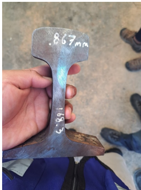
Figura 5.3. Perfil de riel 115 RE con mediciones de variación de perfil en teórico vs perfil real. Tramo 4 del Tren Maya (octubre, 2022).
