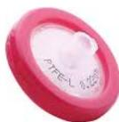
Figura 4.3: Filtros de jeringa de 0.22 micras. Adaptado de FILTROS DE JERINGA DE PTFE HIDROFÓBICO [Fotografía por] labbox (2024).
