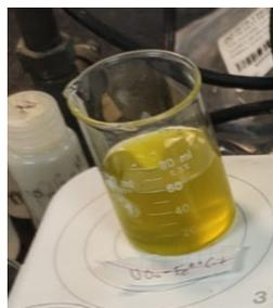
Figura 5.14: Lixiviación sin formación de precipitado de hierro.
