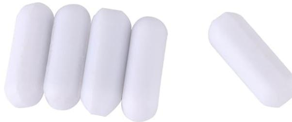
Figura 4.2: Agitadores magnéticos. Adaptado de barras de agitación tipo C. Fotografía por Jectse (2024), Amazon México.
