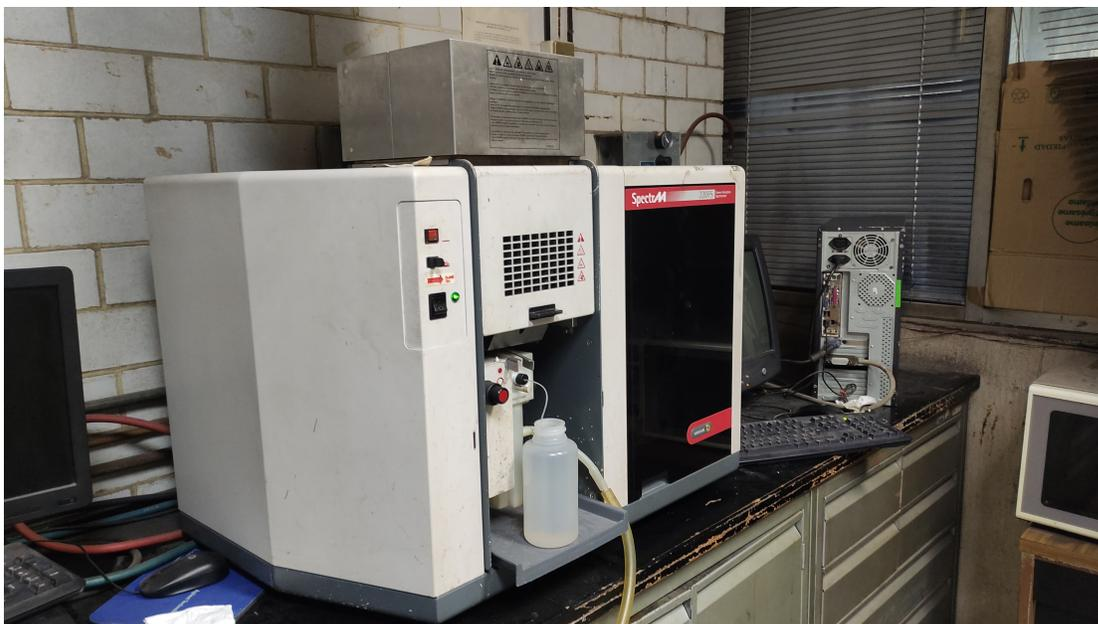
Figura 4.8: Espectrómetro de absorción atómica Varian- SpectraAA 800-D,
