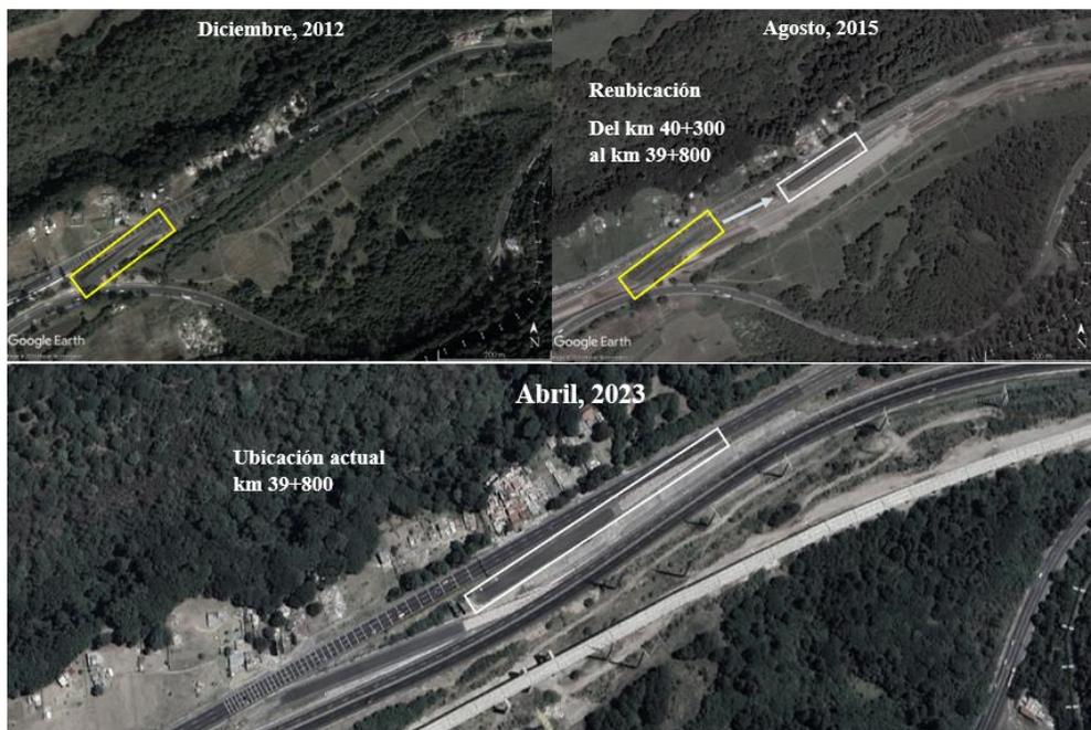
Imagen 44. Reubicación de la rampa de emergencia para frenado de la carretera México – Toluca.
