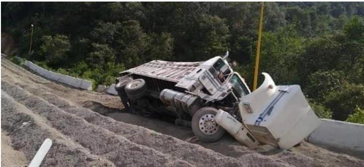
**Imagen 20.** Vehículo volcado en la cama de frenado con surcos longitudinales por [elsoldeorizaba.com.mx](http://elsoldeorizaba.com.mx)
