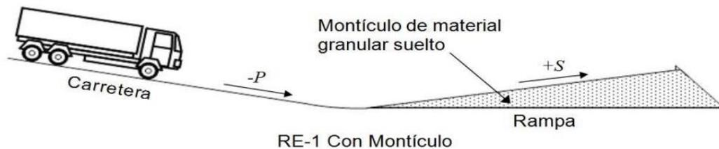
*Nota. Figura obtenida de la NOM-036-SCT2-2016, Rampas de emergencia para frenado en carreteras.*
