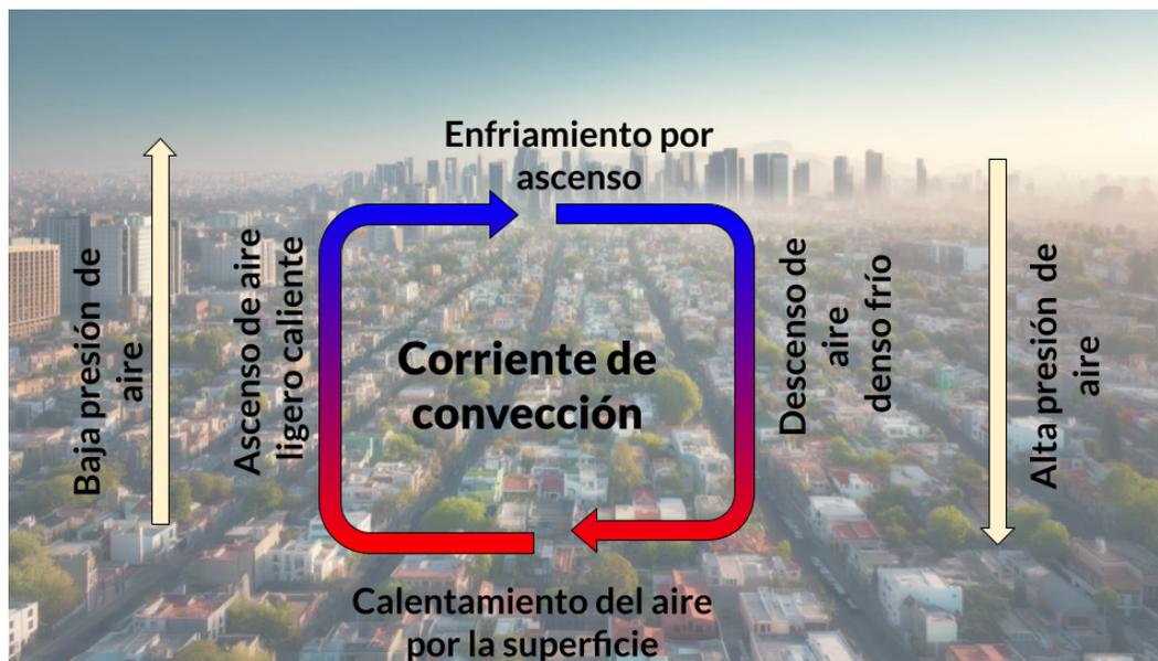
Figura 3.4: Diagrama de la convección atmosférica. El ascenso de aire ocurre mediante canales de baja presión mientras que el descenso en canales de alta presión. Origen: propio
