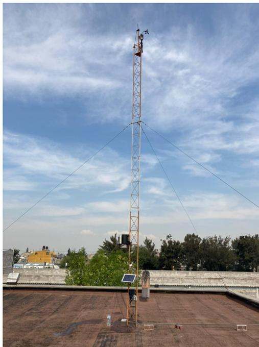
Figura 6.10: Estación meteorológica perteneciente al PEMBU ubicada en el CCH oriente.
