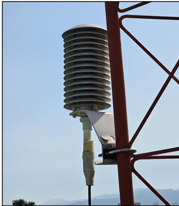
Figura 3.5: Ejemplo de un abrigo meteorológico ubicado en el ICAyCC, UNAM.
