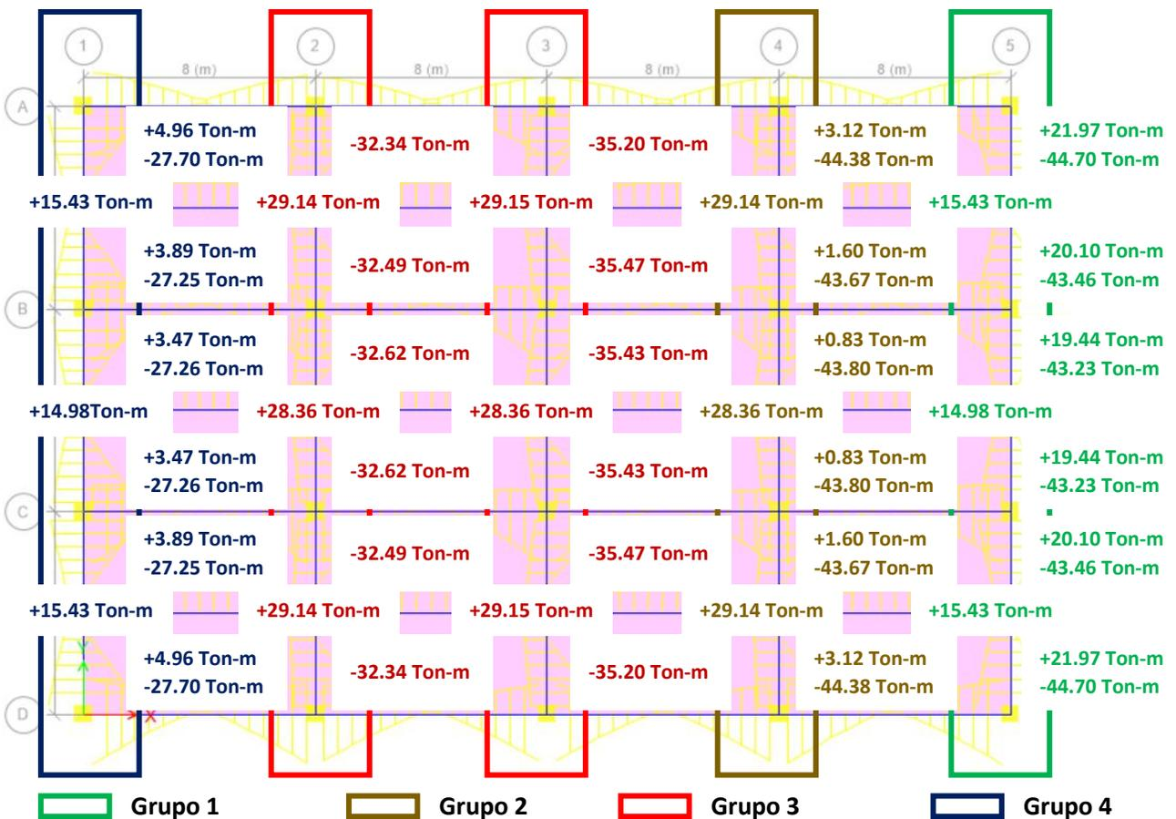
Figura 6.5.3.6.2 Diagrama de Momentos en Vigas-dirección "Y" Modelo 4N Asimétrico.
