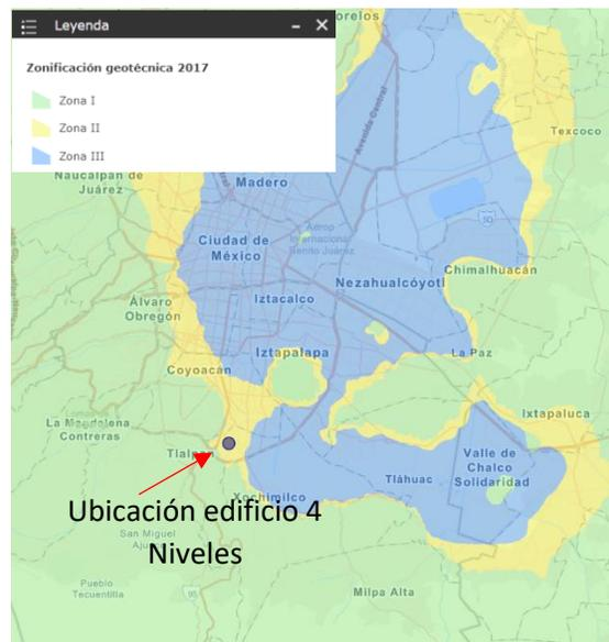
Figura 6.5.3.1 Ubicación dentro de la zonificación geotécnica 2017. (Fuente propia)
