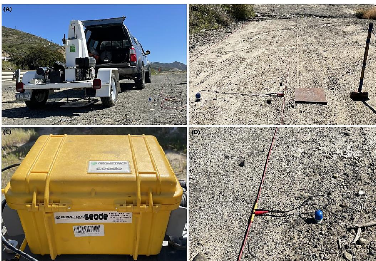
Figura 6. Fotografías del equipo utilizado para la adquisición de datos sísmicos. (A) Fuente GISCO, modelo ESS500. (B) Marro de 16 lb y placa metálica. (C) Sismógrafo GEOMETRICS modelo GEODE de 24 canales. (D) Geófono de frecuencia natural de 2Hz. Las fuentes de impacto (A y B) se muestran al costado de la línea sísmica donde se generaban los disparos (Tomada de Guzmán-Villa, 2022).
