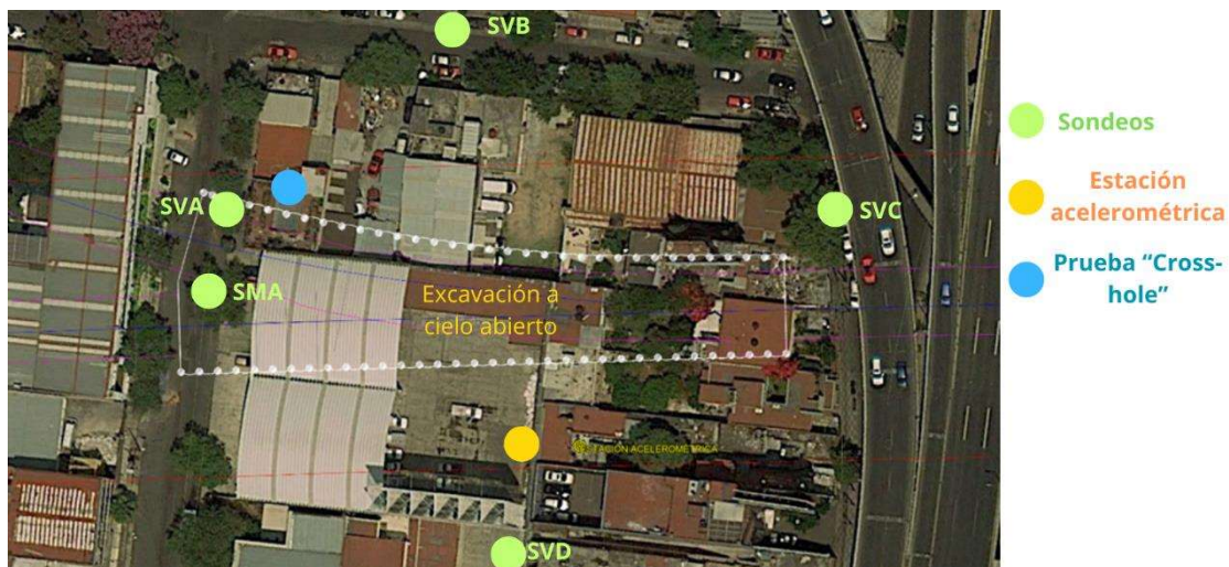
Figura IV.9 Ubicación en vista en planta de la prueba “Cross-hole” (II-UNAM 2023)
