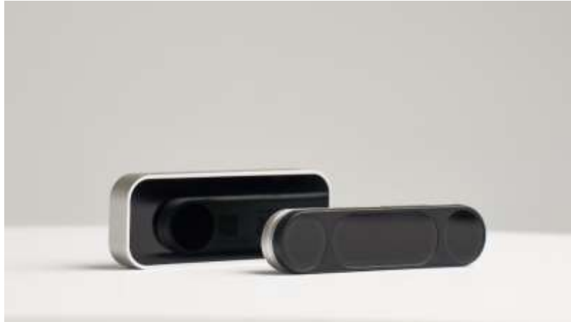
Figura 1.9 Control de Gestos LEAP Motion en su primera y segunda generación [9]
