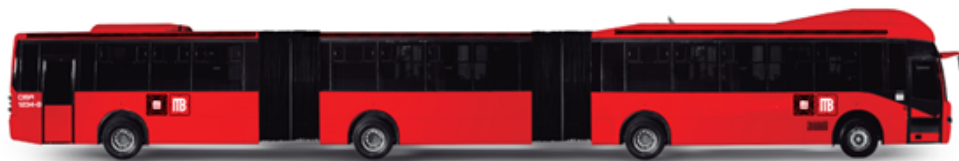
Figura 4.6: Diagrama del autobús biarticulado del Metrobús.
