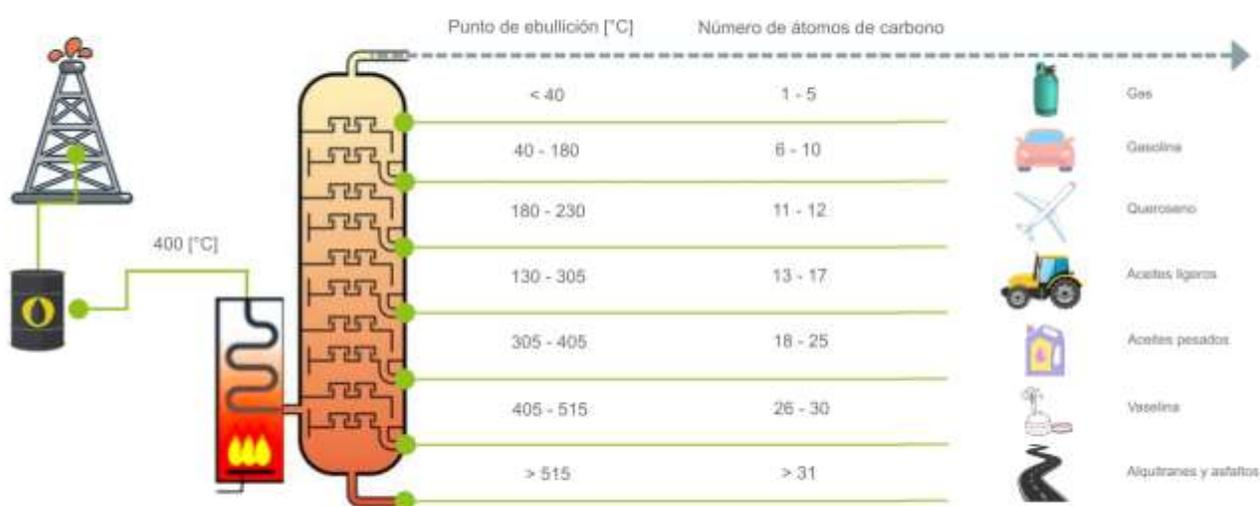
Figura 1. Derivados del proceso de refinación del crudo. El proceso de refinación de petróleo. Oiltanking, 2015.
