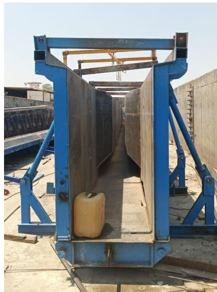
Ilustración 3. Aplicación de desmoldante al molde.
