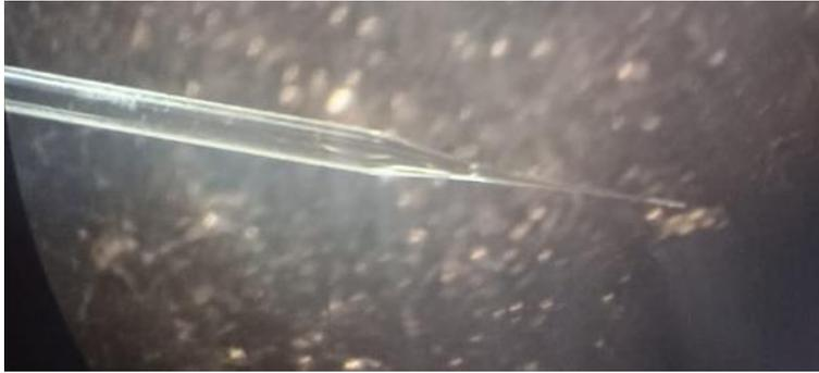
Figura 26. Punta para microelectrodo. Autoría propia
