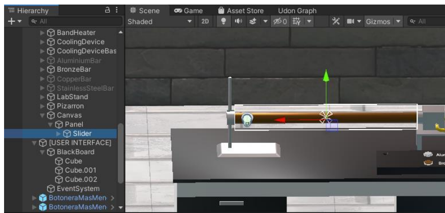
Imagen 12. Slider que representa el sensor de temperatura
