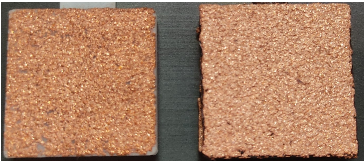
Figura 17 Recubrimiento exitoso, Cobre sobre ABS.
