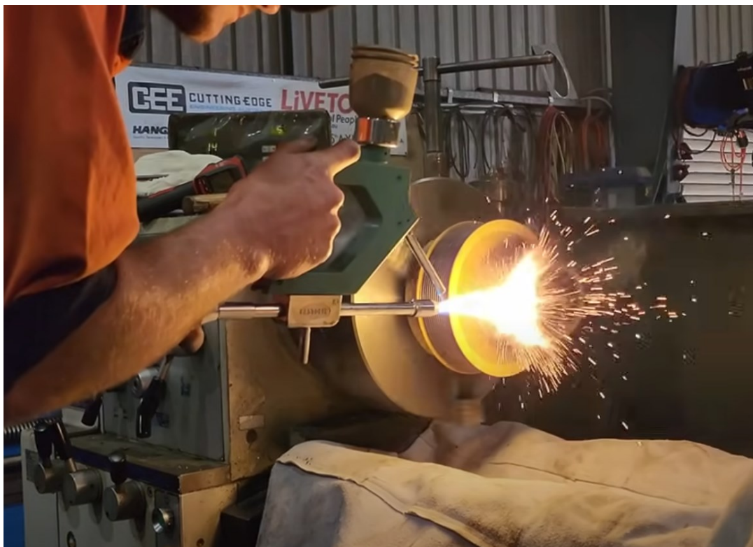
Figura 6: Recuperación de superficies mediante proyección térmica para la reparación de elementos mecánicos. [7]
