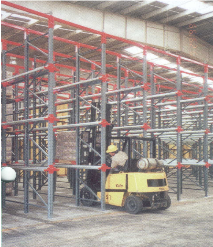
FIGURA 19 OPERACIÓN DE UN RACK DRIVE-IN
