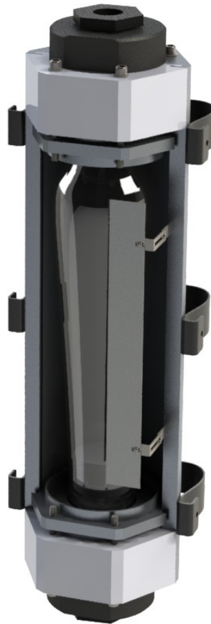
Figura 3.11 Ensamble del modelo paramétrico de rotámetro Fisher&Porter/ABB
