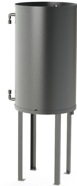
Figura 3.12 Ensamble del modelo paramétrico de tanque de techo abierto
