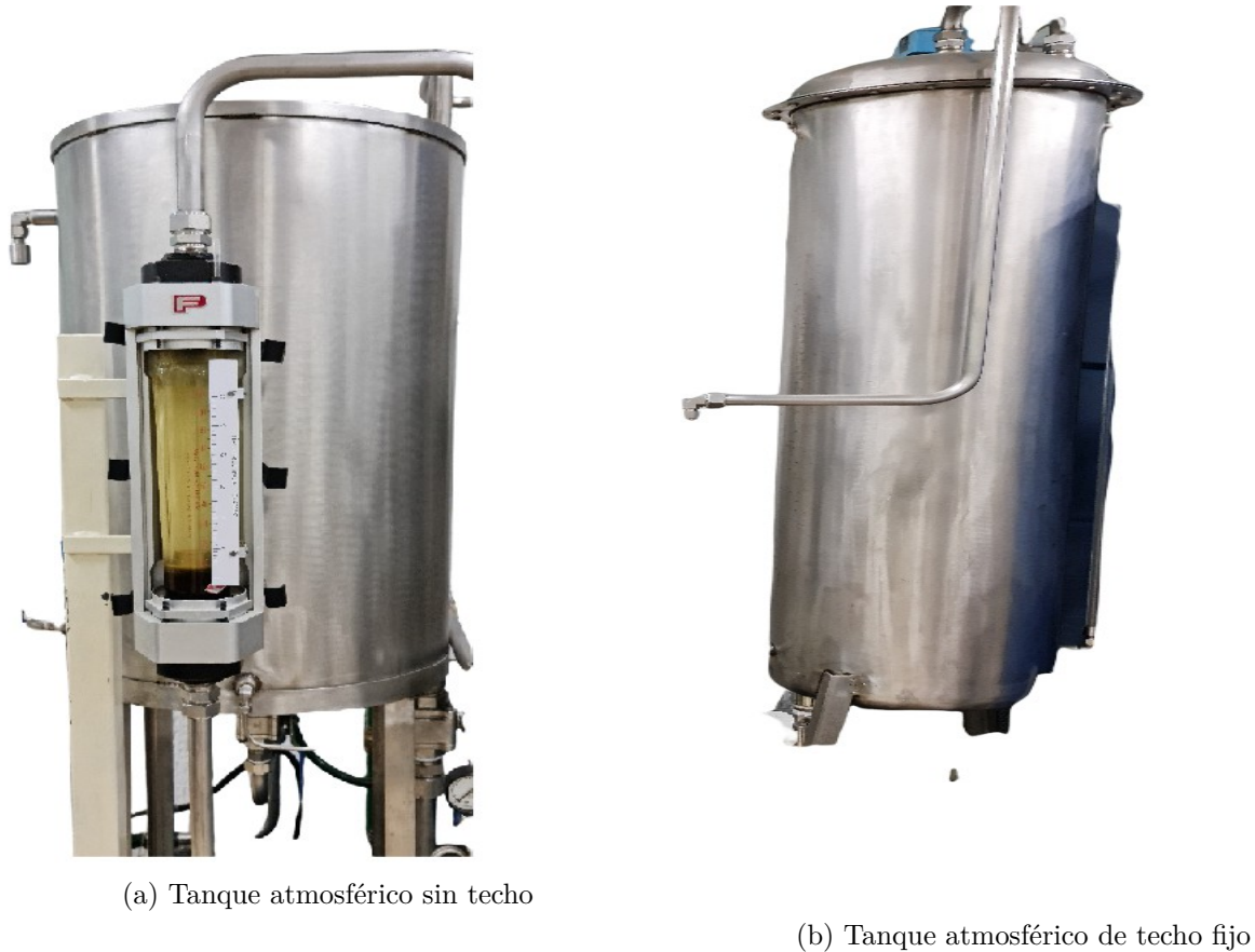
Figura 2.7 Tipos de tanques atmosféricos
