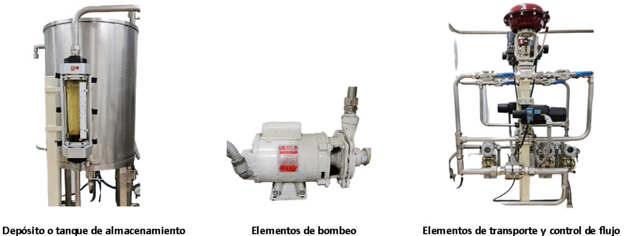
Figura 2.1 Elementos de un sistema hidráulico
