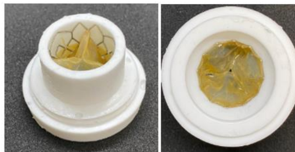
Figura 28. Modelo de fijación aórtica para la realización de las pruebas en dispositivos TAV
