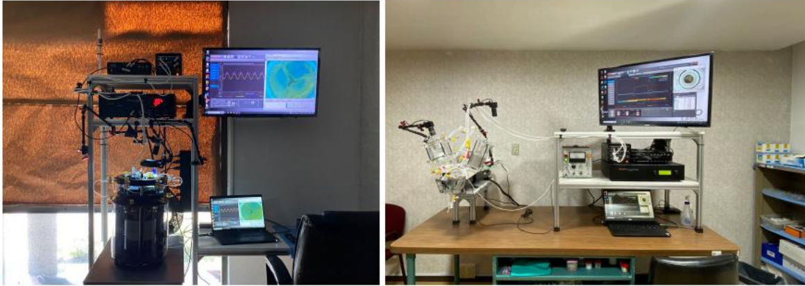
Figura 37 Acomodamiento del área de probadores: HiCycle System (Izquierda). Pulse Duplicator (Derecha). Cada área cuenta con el equipo necesario para su uso y calibración exclusivo.
