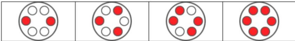
Figura 23. Configuración de montaje para mantener balanceado el sistema Nota: Es recomendable que el mismo tipo y tamaño de muestra sea usado en cada cámara de prueba. [65]
