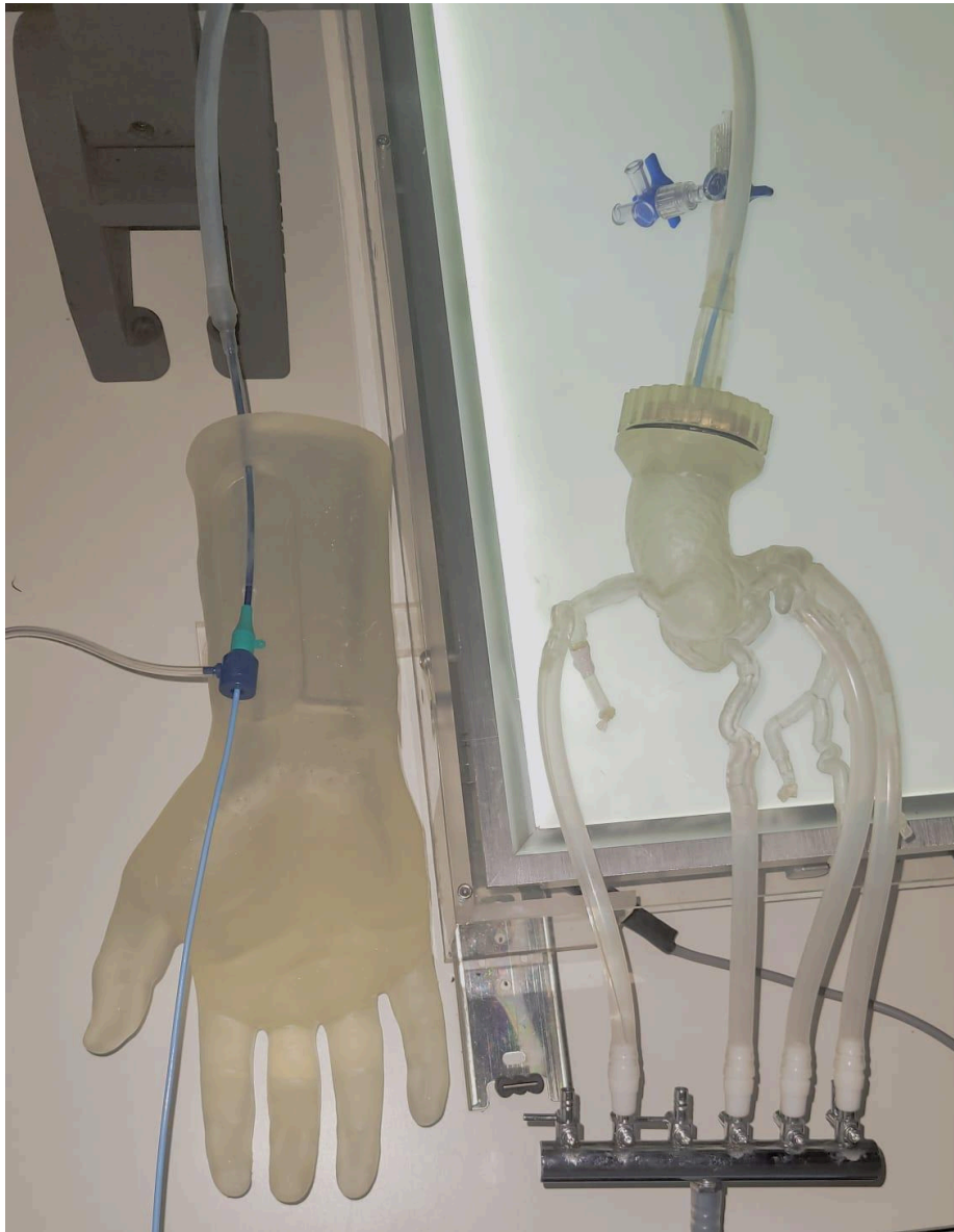
Figura 4. Sistema hidráulico. Modelos anatómicos de muñeca para punción radial a la izquierda y aorta a la derecha montados en el sistema hidráulico. Esta foto corresponde a una prueba en donde ya se realizó la inserción del stent .
