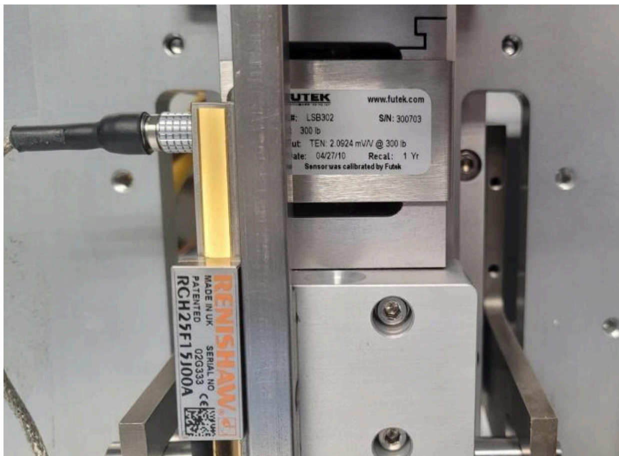
Figura 14. Sistema de encoder óptico y celda de carga . Del lado izquierdo sobre la cinta dorada se encuentra el encoder óptico y en la parte superior la celda de carga .
