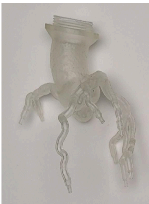
Figura 1. Arteria aortica adaptada con conexiones para el sistema hidráulico. La impresión fue realizada en Clear Resin y se utilizó la impresora 3D Form 3BL de Formlabs.
