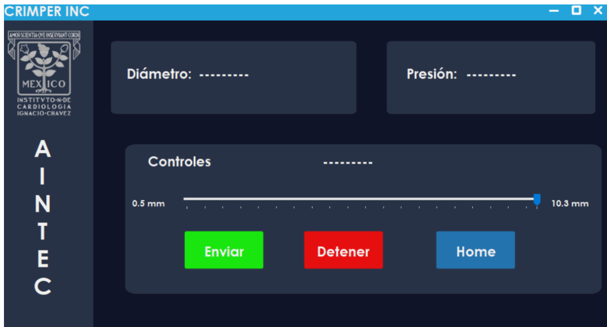
Figura 16. Interfaz gráfica de control y visualización de datos. En la parte superior tiene las medidas de diámetro y presión. Los controles incluyen una barra de seguimiento que indica el diámetro de destino (En un rango de 0.5 mm a 10.3 mm) y botones para enviar y detener el sistema.
