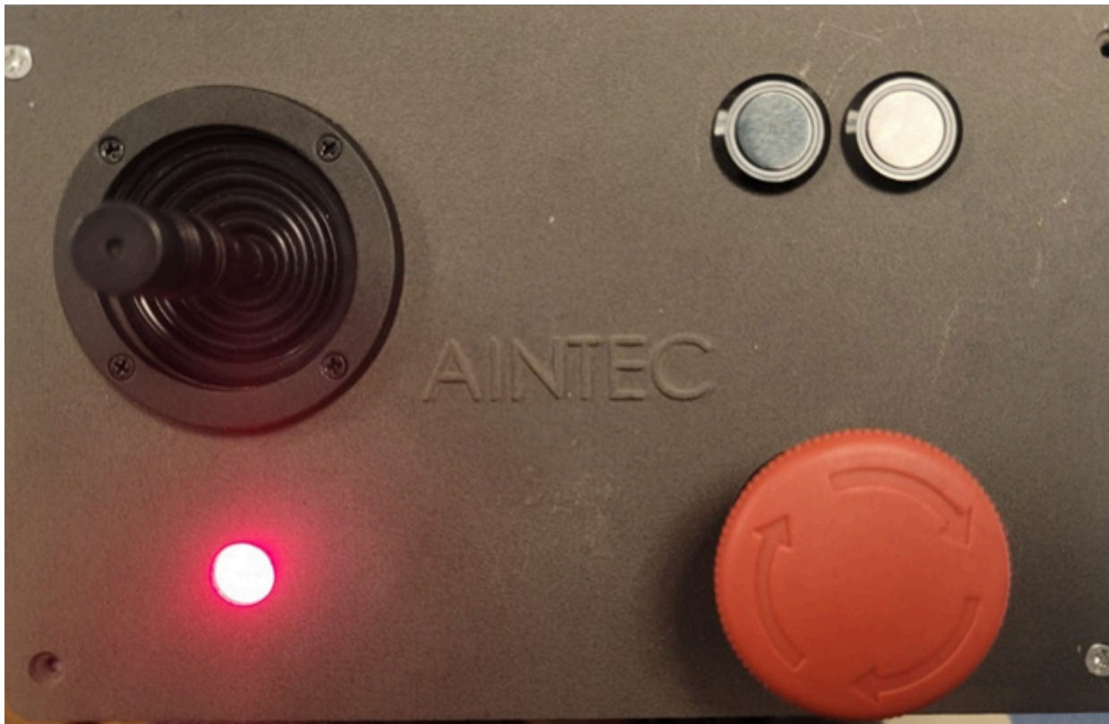
Figura 9. Sistema físico de control. Incluye un joystick y 2 botones para el control del sistema, con un botón de emergencia que, al activarse, enciende un LED rojo.
