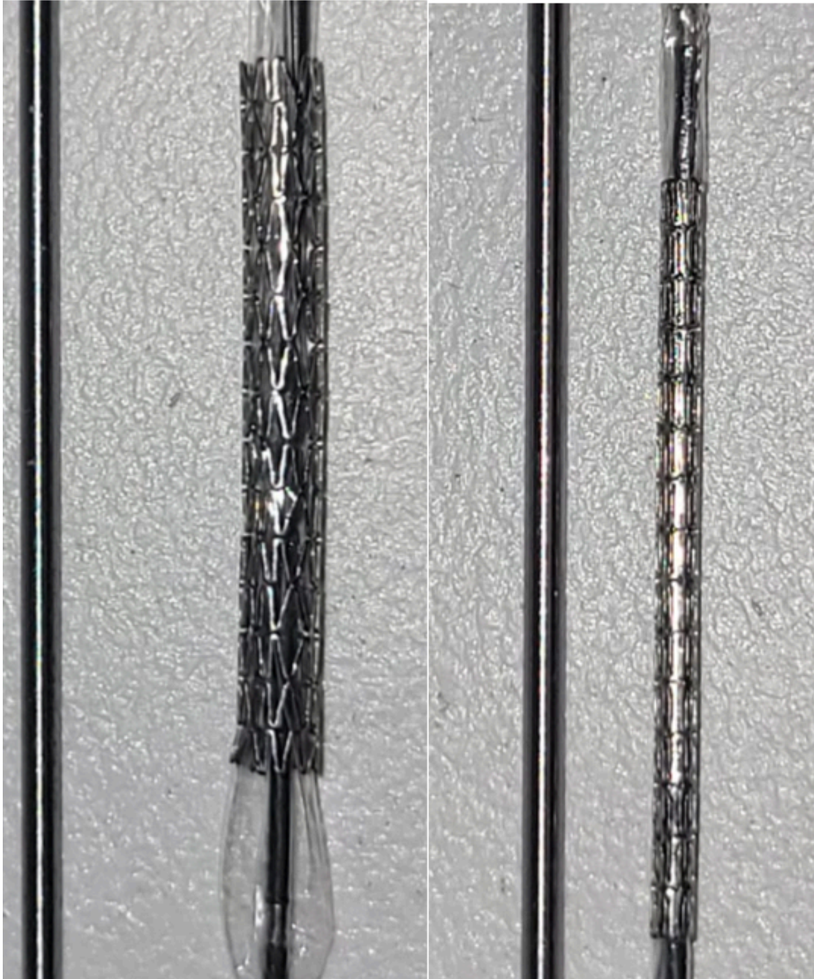
Figura 20. Prueba de crimpado. A la izquierda, el stent expandido y montado sobre el balón angioplástico; a la derecha, el stent después de ser crimpado. La barra de referencia tiene un diámetro de 1 mm.
