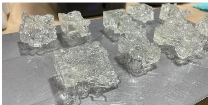
Figura 5. 14. Piezas con soportes recién salidas de la impresora.
