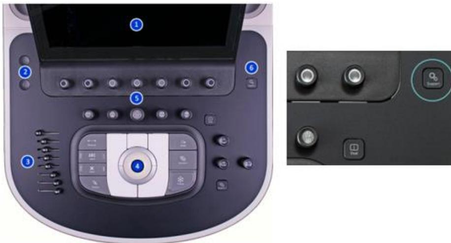
**Figura 1:** Imagen del módulo de control: 1. Pantalla táctil, 2. Controles de encendido y modo de suspensión, 3. Controles TGC, 4. Trackball, 5. Controles de modo, 6. *Philips SupportConnect*.
