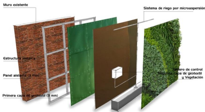
Figura 6 Esquema del sistema de muro verde de la compañía Plantica Obtenido de: http://tinyurl.com/4s4vx5c9
