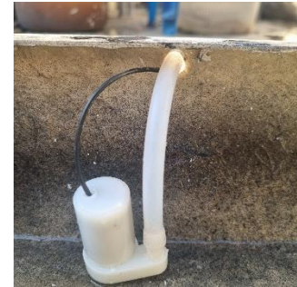
Figura 33 Reservorio de agua con perforación para tubería de 1/4" de PVC
