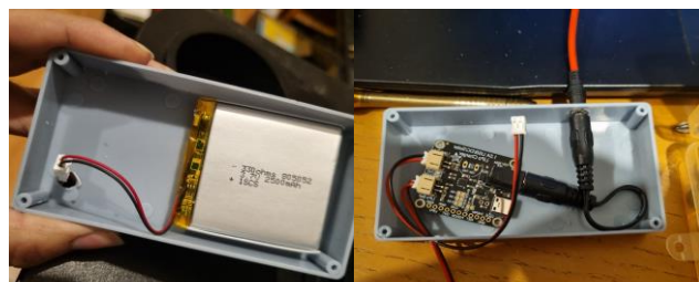
Figura 52 Fotografías de gabinetes de plástico de batería LiPo y tarjeta cargadora de batería LiPo antes de ser cerrados.
