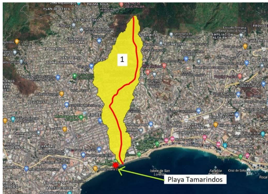
Figura 14 Parteaguas y cauce principal de la microcuenca 1
