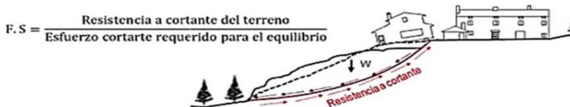
Ilustración 7 FACTOR DE SEGURIDAD
