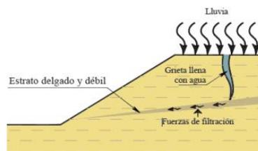
Ilustración 1 TALUD SOMETIDO A LLUVIA (Nota: Recuperado (Nota: Recuperado de Tesis digital. (s. f.). <http://132.248.9.195/ptd2015/agosto/0734257/Index.html>)
