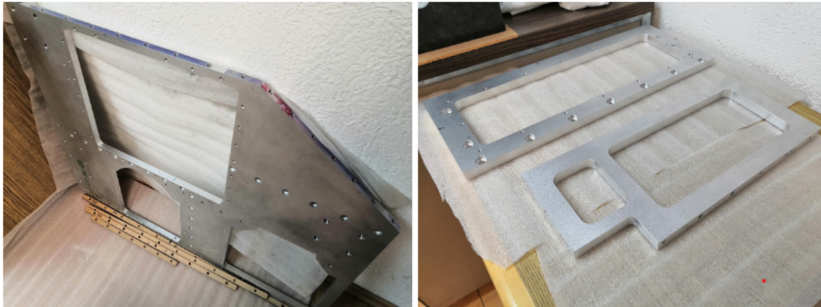
Figura 4.11: Placas DD-ME-SST-P2 (Izquierda), DD-ME-SST-P8B y DD-ME-SST-P19 (Derecha) completamente terminadas. Nótese que en la DD-ME-SST-P2 se aprecian las regletas empleadas en ella. Imagen de autoría propia.
