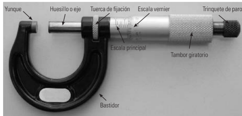
Figura 2.9: Micrómetro y las partes que lo componen. Imagen extraída de [7].
