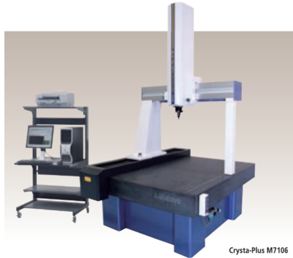
Figura 2.10: Máquina de Medición por Coordenadas Mitutoyo modelo 7106, modelo que se encuentra en el laboratorio de metrología del Instituto de Astronomía. Imagen extraída de [14].
