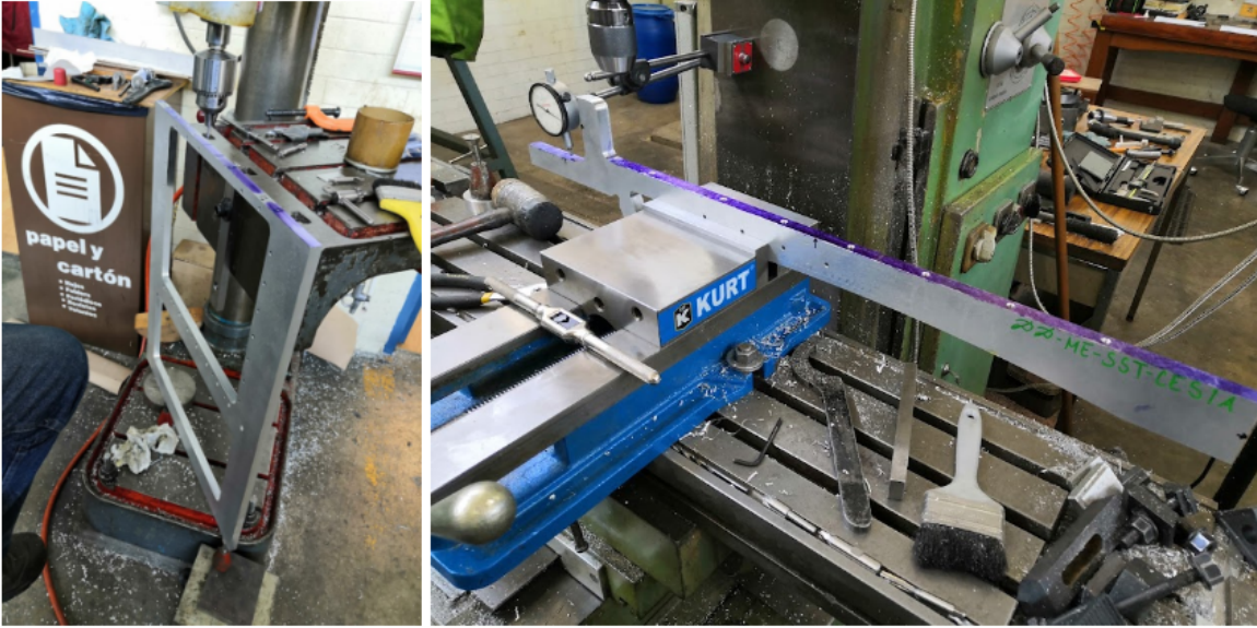
Figura 4.7: Roscado de barrenos laterales para la placa DD-ME-SST-P7 con un taladro de columna (Izquierda) y maquinado de barrenos laterales para la placa DD-ME-SST-CES1A con una fresadora convencional manual (Derecha) en el TMP. Imagen de autoría propia.
