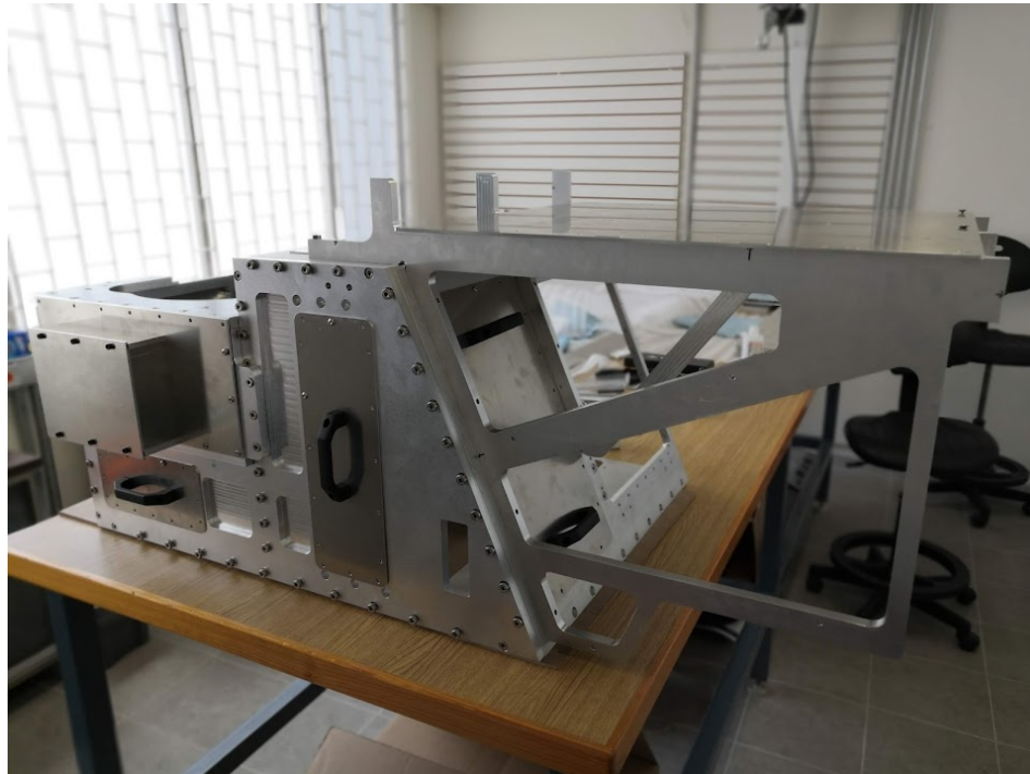
Figura 4.29: Estructura de soporte de DDRAGO ensamblada de manera preliminar, nótese la ausencia de la placa DD-ME-SST-P1 que va hacia el puerto nasmyth del telescopio y la placa DD-ME-SST-CYSP5B. Imagen de elaboración propia.
