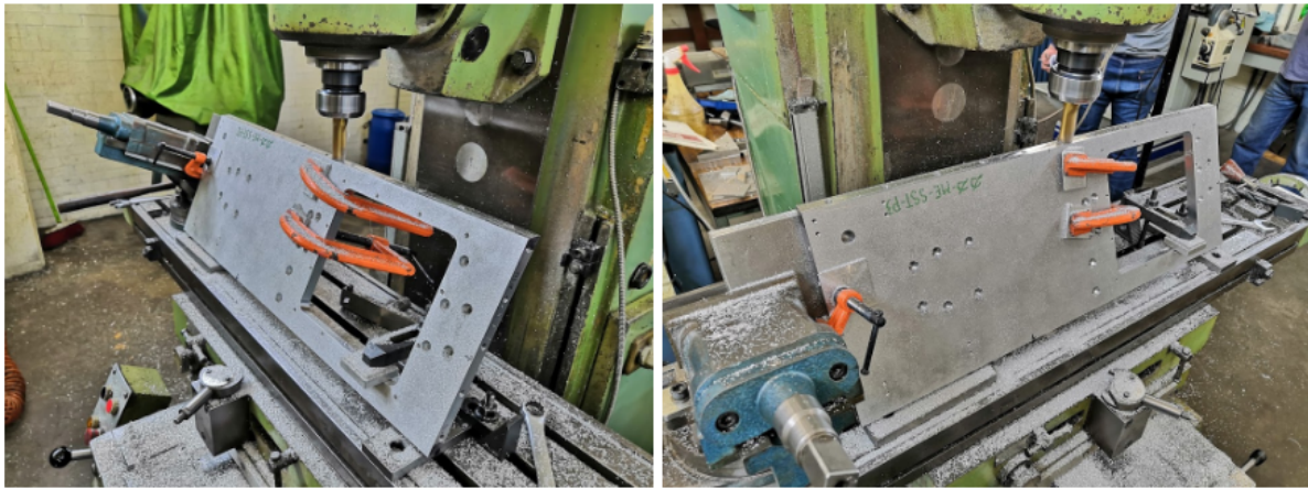
Figura 4.6: Uso de las regletas de MDF para la evaluación de un arreglo de barrenos sobre una de las caras de la placa DD-ME-SST-PX. Nótese el código de la misma así como la notación marcada sobre la cara de la placa. El sentido de uso de la regleta es marcado con una flecha que coincide con una marcada en la cara frontal de la placa. Imagen de autoría propia.
