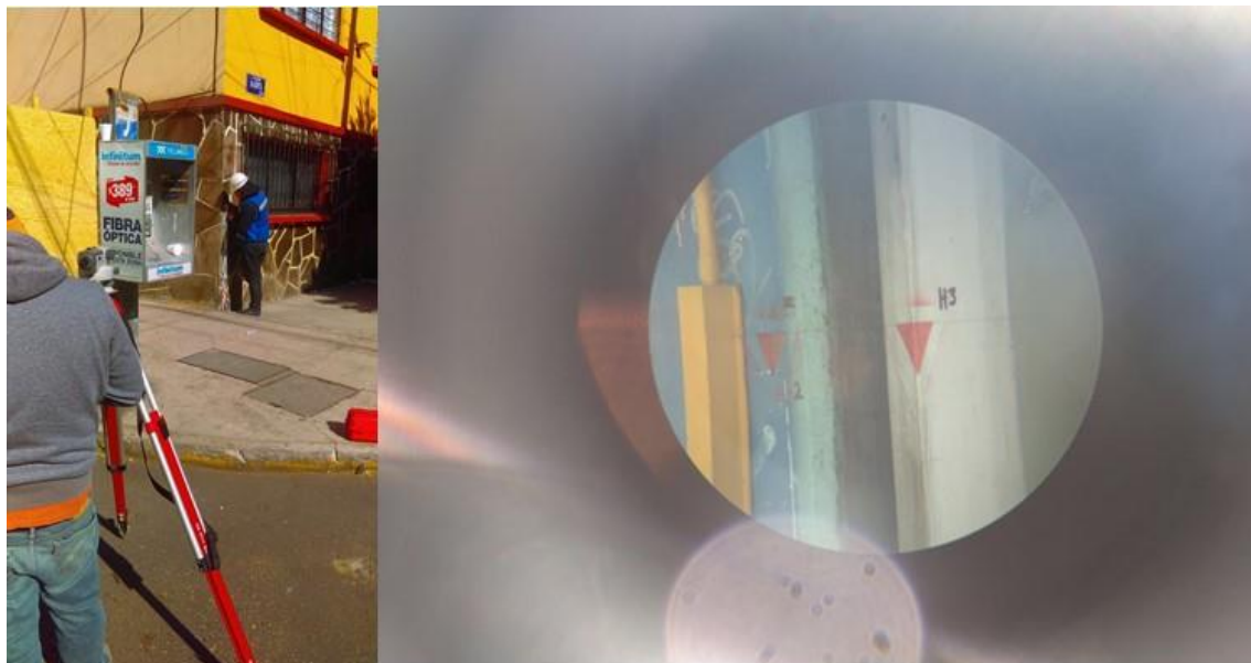
Ilustración 35 Ejemplo de Verificación de niveles de control. Fuente Propia
