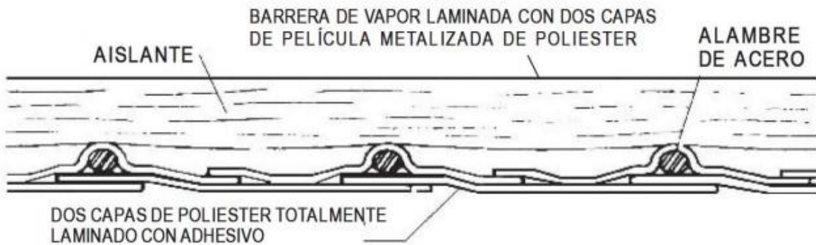
Ilustración 26. Construcción y materiales de ducto G flex de Glassfiber. (GLASSFIBER, 2023)
