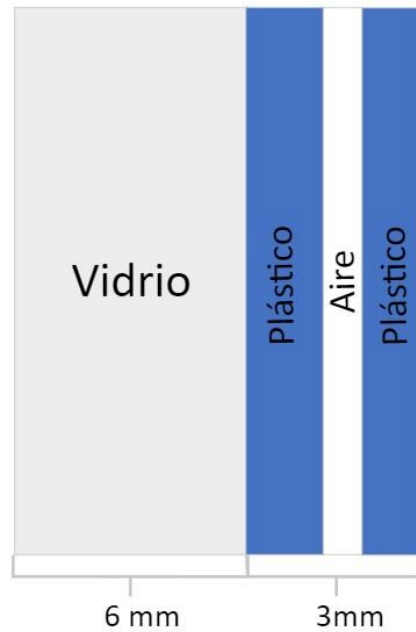
Ilustración 16. Esquema de aislamiento de ventanas.
