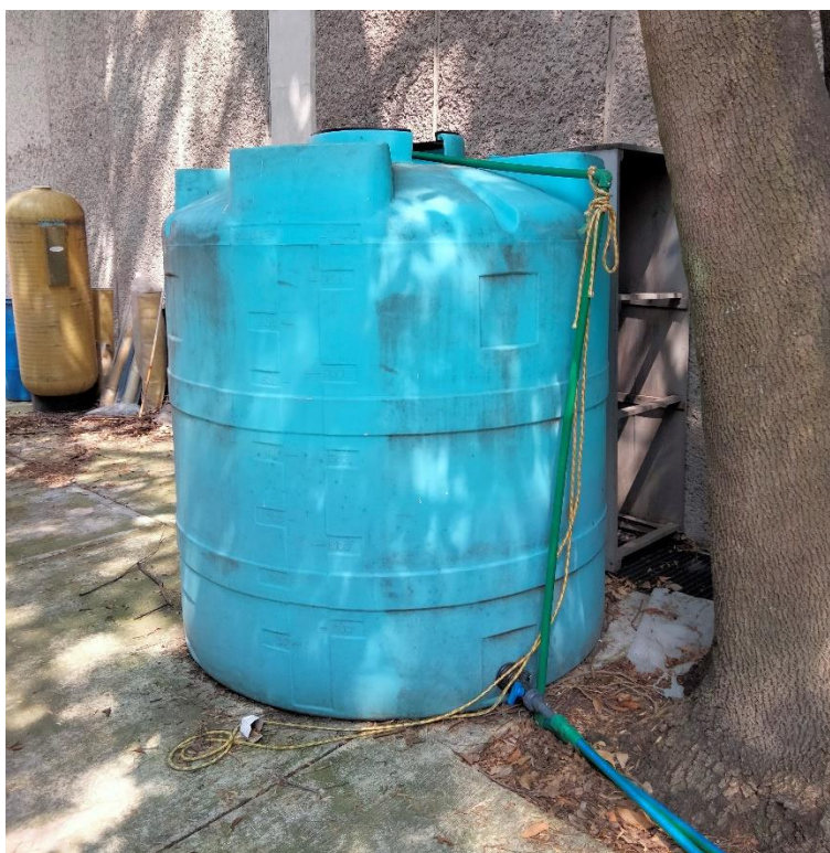
Ilustración 23. Depósito de agua para simular el intercambiador geotérmico
