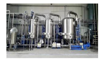
Además de los métodos de operación, existen diferentes tipos de evaporadores, los cuales varían en sus dimensiones y funcionamiento, dependiendo el tipo de aplicación para el que sean requeridos. La mayoría de los evaporadores llevan al interior de tubos el vapor de agua que condensa el material sobre tubos metálicos, excepto en algunos casos donde el material a evaporar fluye dentro de los tubos. Los principales tipos de evaporadores son:
