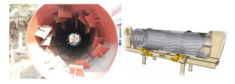
Figura 100. Interior de un secador rotatorio
