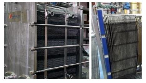
Figura 165. Intercambiadores de calor de placas
