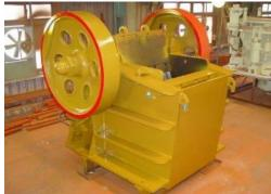
**Figura 171.** Trituradora de mandíbulas
