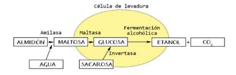
**Figura 191.** Diagrama del proceso de fermentación alcohólica en la fabricación de pan (Buehler, 2012)
