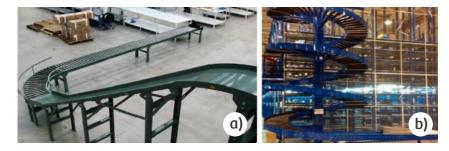
**Figura 49.** Transportadores por gravedad de a) Plano inclinado y b) Espiral
