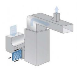
**Figura 36.** Instalación de un filtro de aire en un sistema de calefacción Adaptado de (EPA, 2019)
