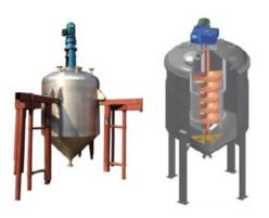
**Figura 239.** Reactor de saponificación
