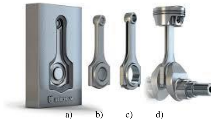
Fig. 2.6 a) Dado de biela. b) Preforma de biela. c) Biela forjada d) Ensamble de forja. (Uddeholm, 2017)
