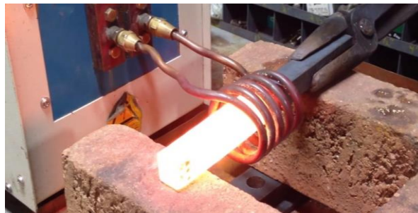
Fig. 1.17 Calentamiento inductivo de un lingote de acero. (Ajmal, 2018)
