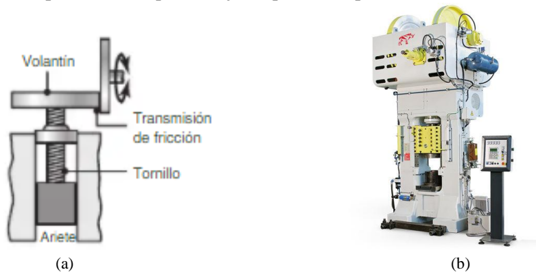
Figura 1.10 (a) Prensa de tornillo esquema (Kalpakjian, S. 2008) y (b) prensa de tornillo real (MECOLPRESS, s.f)
