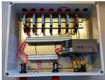
Figura 3.4: Interior de la caja de control y adquisición de datos fabricada por el departamento *Aero-Thermo-Mechanics* de la ULB [27].
