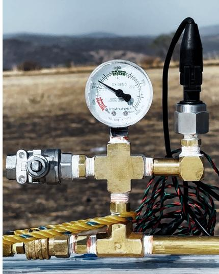
Figura 6.9: MAN y SPI funcionando durante una prueba de quemado estático.
