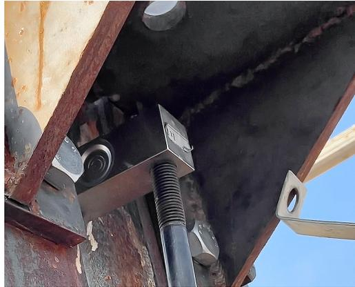
Figura 6.6: Celda de carga de 500 [kg] siendo fijada en la estructura del banco de pruebas de quemado estático.
