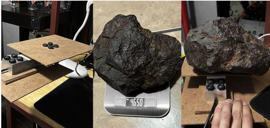
Figura 6.4: Proceso de calibración de la celda de carga, colocando encima uno de los pesos usados.
