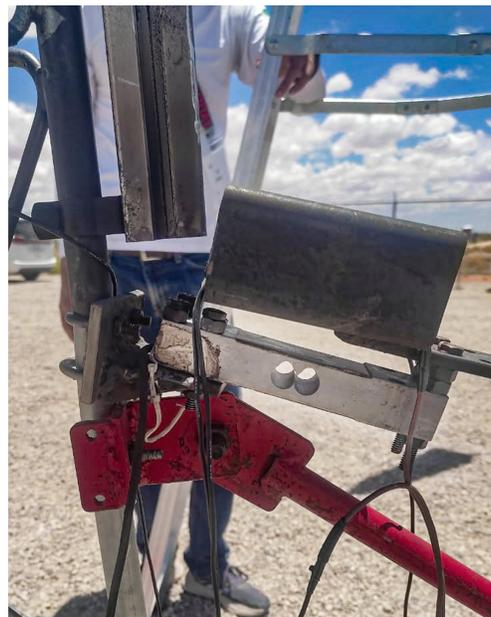
Figura 6.7: Celda de carga de 200 [kg] colocada al inicio del riel de lanzamiento.
