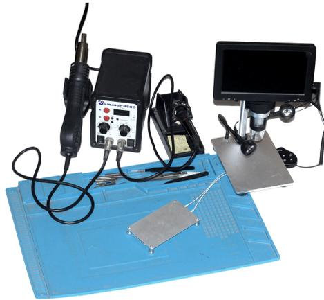
Figura 6.2: Equipo y herramientas usadas para la integración de componentes en la tarjeta de circuito impreso.
