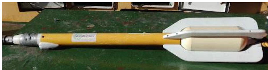
Figura 10. Magnetómetro marino G-877 de la marca Geometrics. Imagen del magnetómetro que fue utilizado en la campaña Perdido 2.
