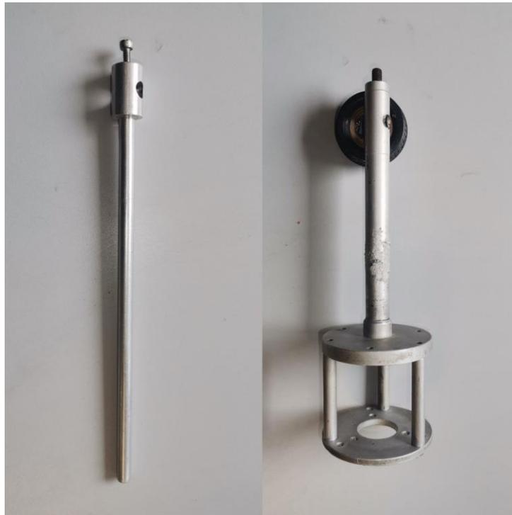
*Ilustración 7 Péndulo y Brazo del sistema*
