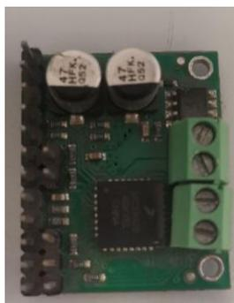
*Ilustración 6 Driver controlador del motor*
