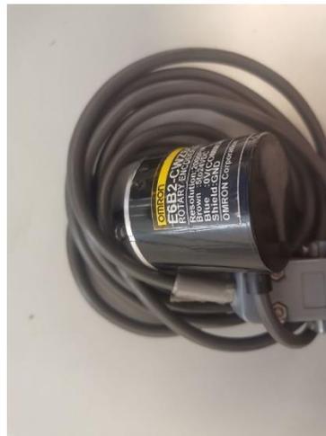
*Ilustración 4 Encoder EB2CWZ6C*
