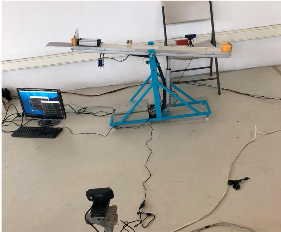
*Figura 19 Prototipo para la práctica remota de "Planos inclinados"*
