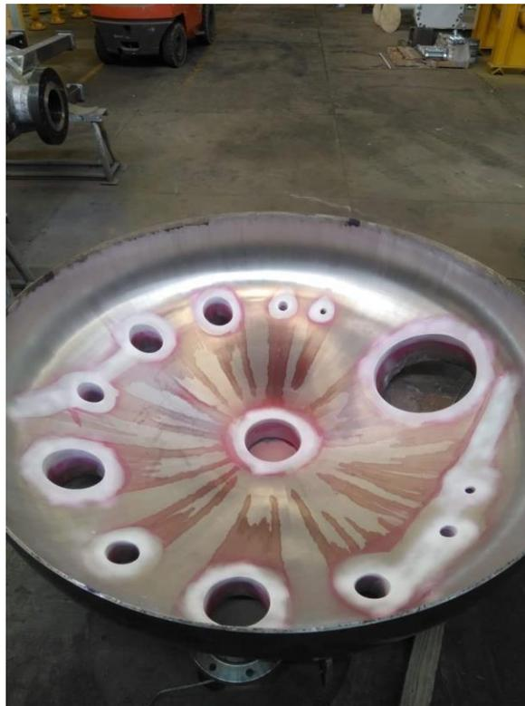
*Imagen 9. Tapa semielíptica con boquillas en prueba de líquidos penetrantes.*
