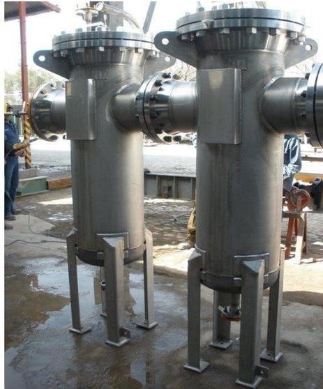
*Imagen 2. Filtros Strainers en arreglo dúplex.*
