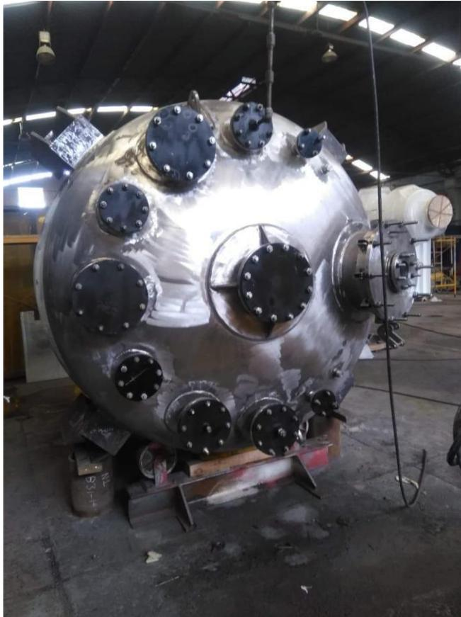
*Imagen 11. Reactor siendo sometido a la prueba neumática.*
