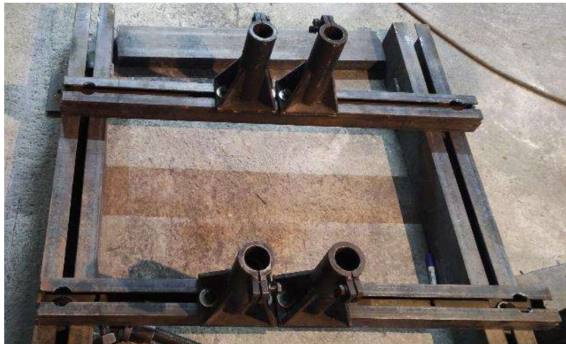
imagen 3.16: torres de nivelación para el motor
