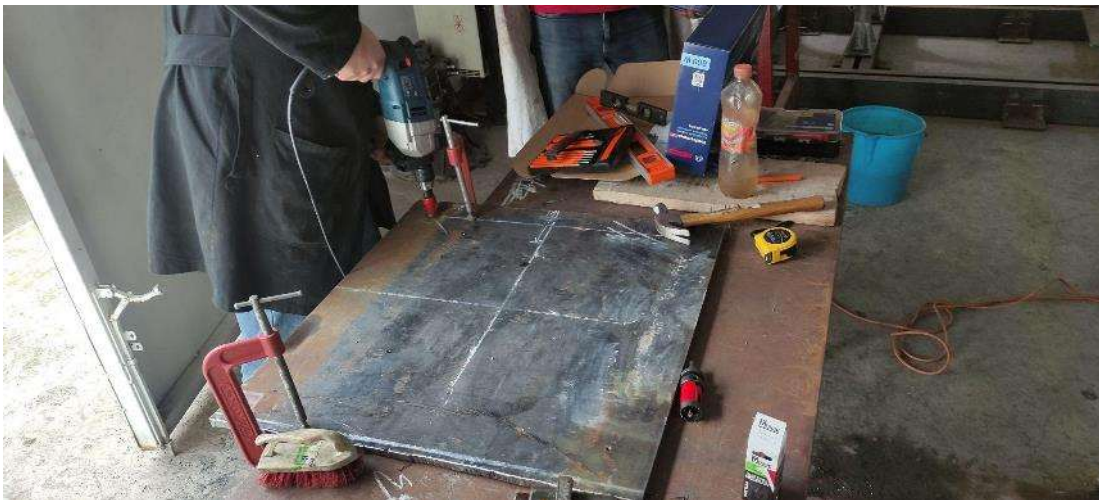
imagen 3.10: barrenado de la placa de acero
