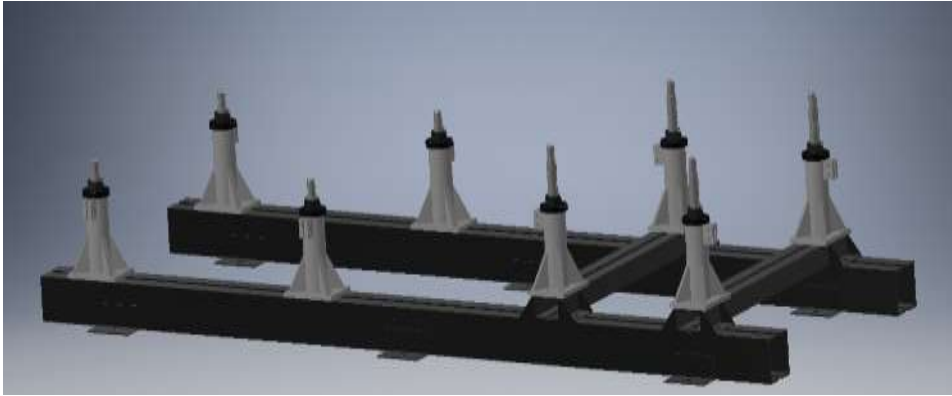
Imagen 2.2: CAD de la iteración 1 del chasis inferior
