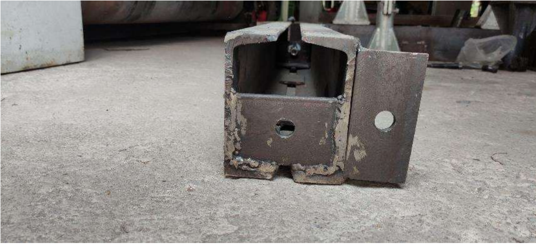
imagen 3.6: travesaños con ángulos para poder unirlos a los largueros
