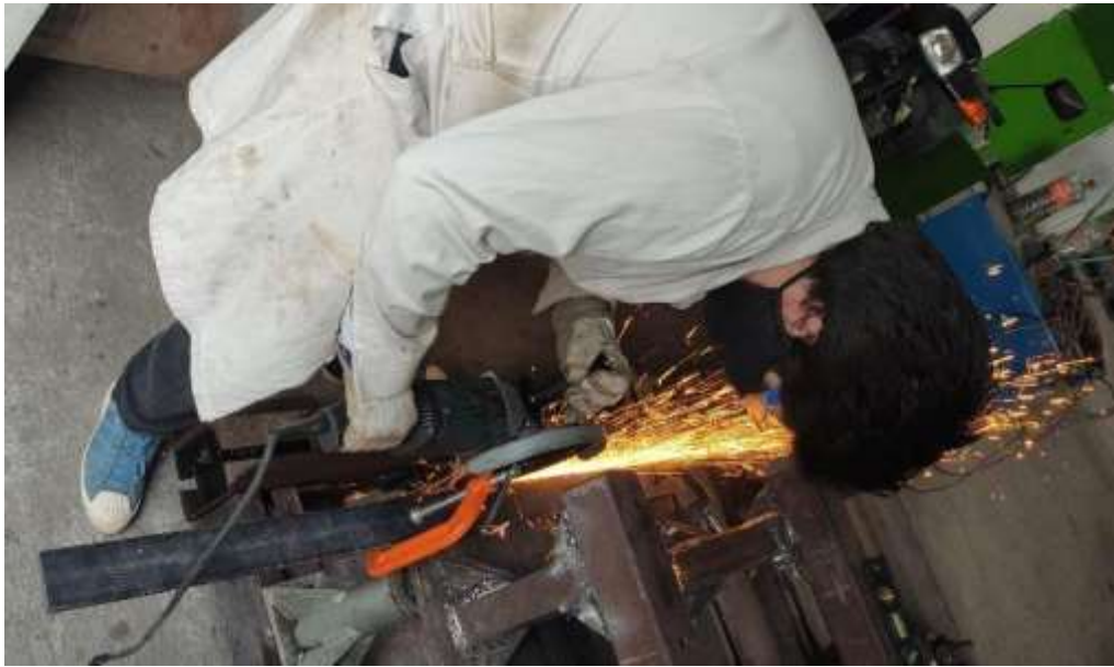
imagen 3.9: desbaste de placa de acero
