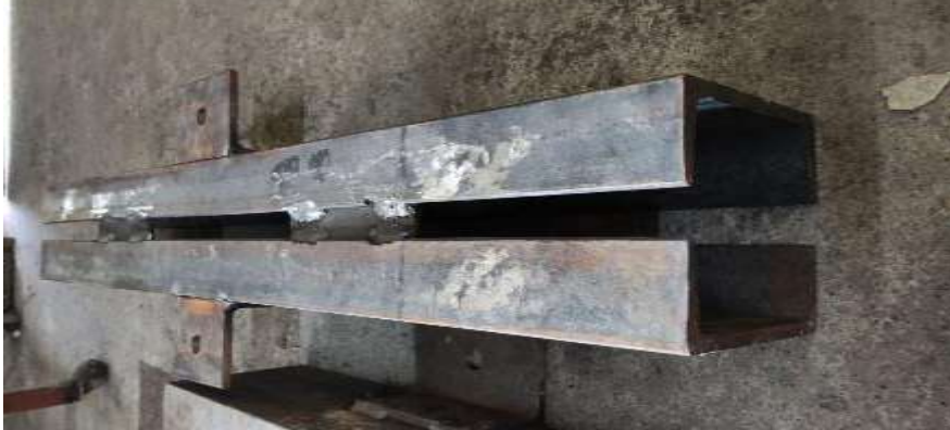
imagen 3.4: ángulos para anclar la estructura al suelo
