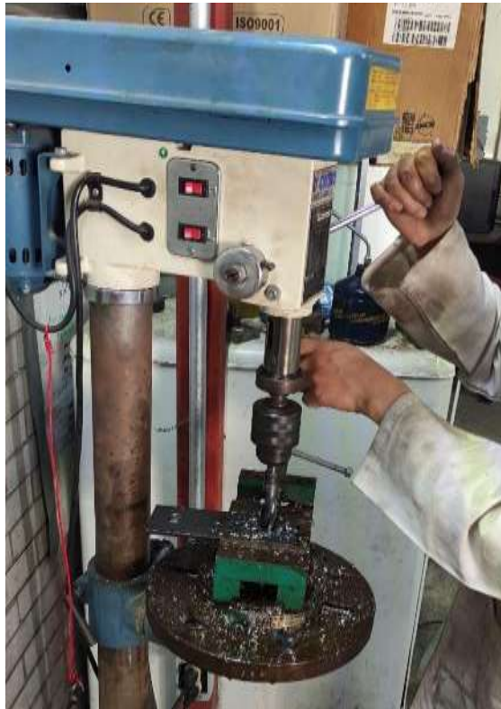
imagen 3.5: barrenado de solera para unir larguero con travesaño
