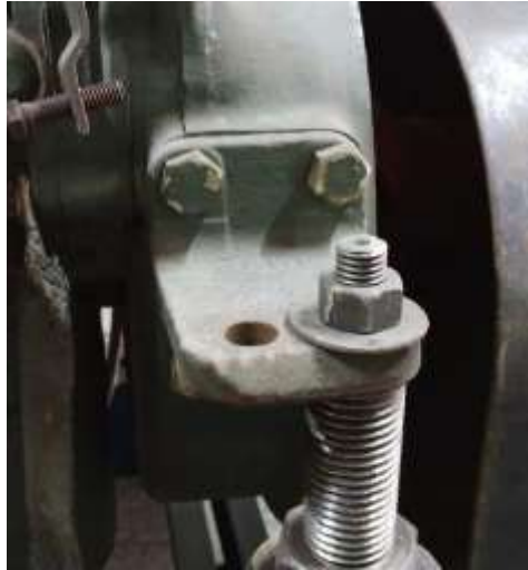
Imagen 2.17: Soporte del motor con tornillo de su torre de nivelación
