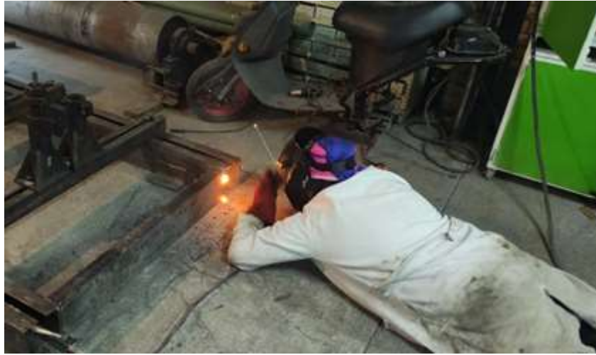
imagen 3.17: unión del chasis inferior
