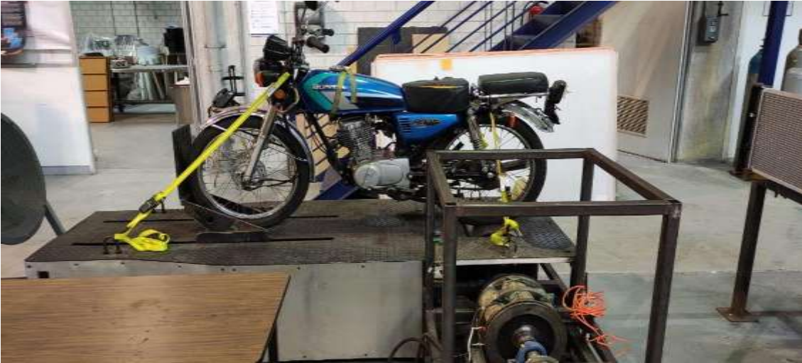
Imagen 1.2: Dinamómetro para motocicletas de la UNICE
