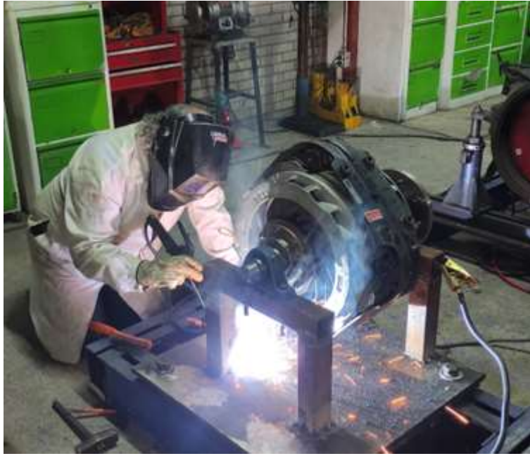
imagen 3.13: soldadura con electrodo revestido
