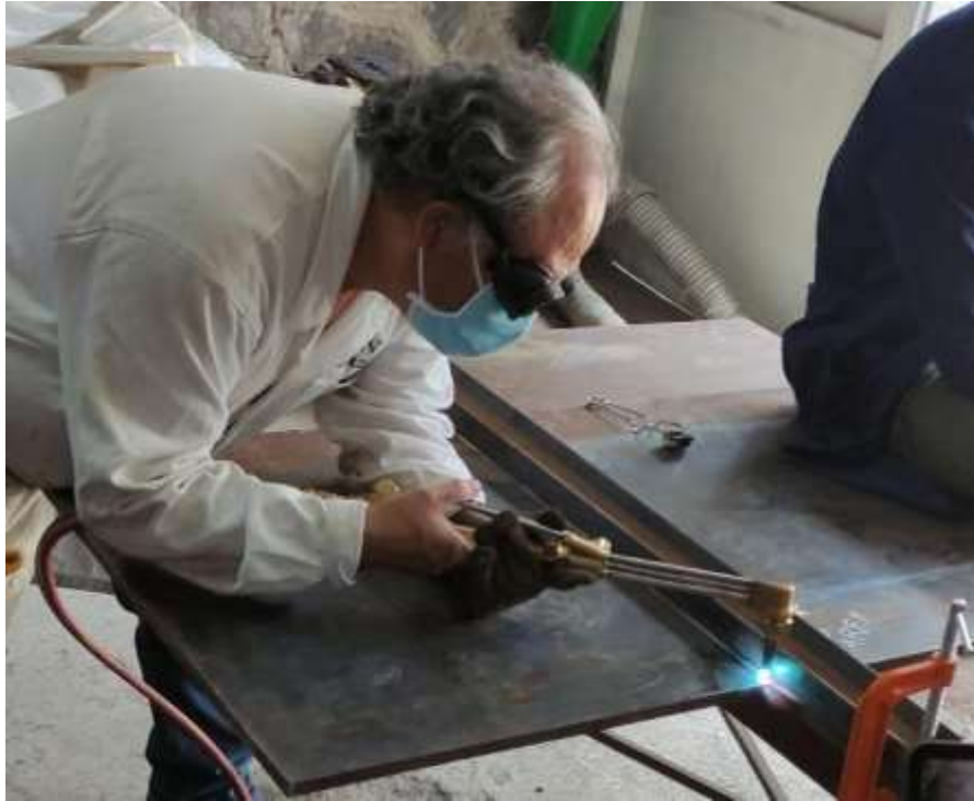
imagen 3.8: corte con oxiacetileno
