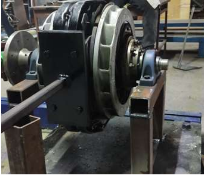
imagen 3.18: PAU con brazo de palanca para la celda de carga
