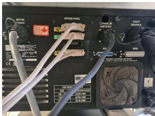
Ilustración 5: Vista trasera del C500 con las conexiones de las señales del robot
