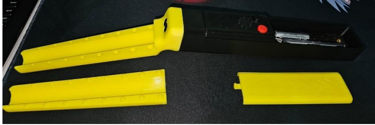
Figura 21 Prototipo funcional del mango sin ensamblar.
