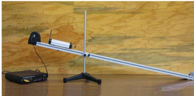
Figura 1 Configuración práctica “movimiento rectilíneo uniformemente variado” [2].
