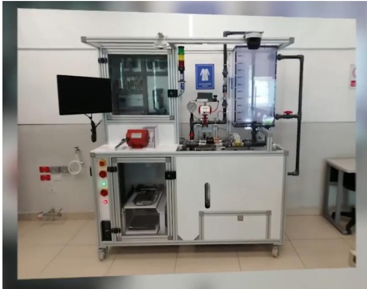
Figura 13 Laboratorio remoto de prácticas relacionadas con el control automático de procesos [10].
