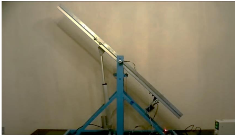
Figura 83 Prueba del sensor final de carrera para el límite derecho.
