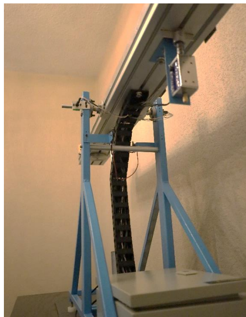
Figura 99 Ensamble de la cadena en el prototipo.
